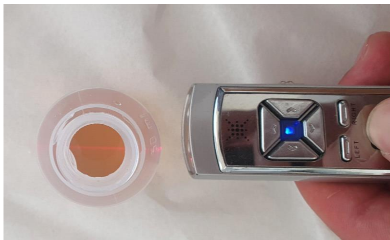
Slika 14. Tyndallov efekt za otopinu pH = 7
