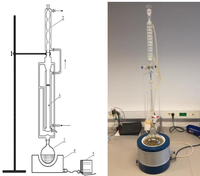
**Slika 11.** Aparatura za vodenu destilaciju po Clevengeru: 1- tirkvica s okruglim dnom, 2 - Liebigovo hladilo, 3 - središnji dio aparature, 4 – električni grijač, 5 – otpornik promjenjive struje (reostat)
