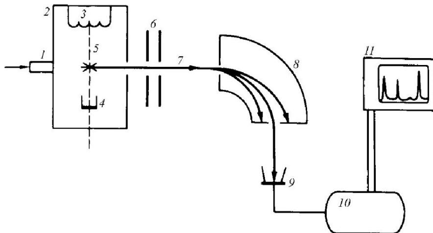
**Slika 9.** Spektrometar masa - 1. sustav za unošenje uzorka; 2. ionski izvor; 3. katoda; 4. anoda; 5. elektronski snop; 6. električno polje; 7. ionski snop; 8. magnetsko polje; 9. detektor; 10. elektronička obradba signala; 11. zapis spektra<sup>43</sup>
