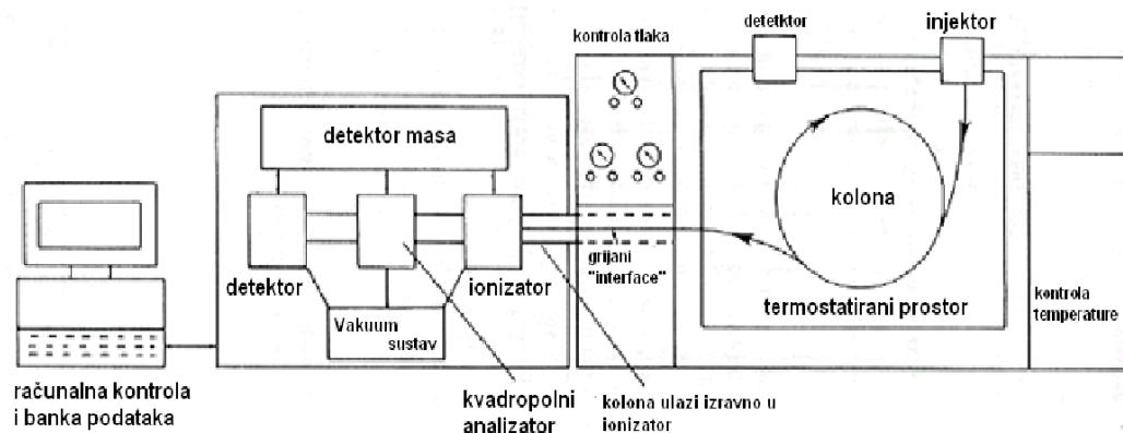
**Slika 10.** Shematski prikaz vezanog sustava plinska kromatografija–spektrometrija masa (GC-MS)<sup>42</sup>
