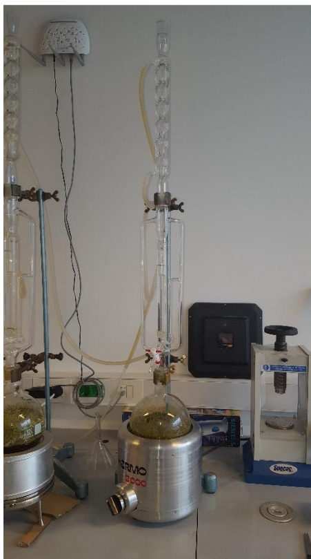
Slika 2.15. Hidrodestilacija praha biljke M. oleifera .
