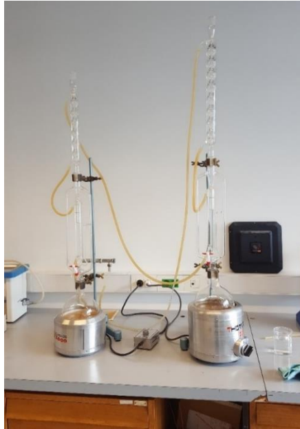
Slika 2.13. Hidrodestilacija L. meyenii .
