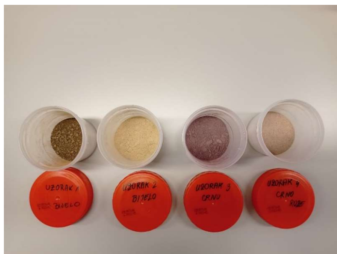
Slika 3. Osušeni i homogenizirani uzorci vinskog taloga
