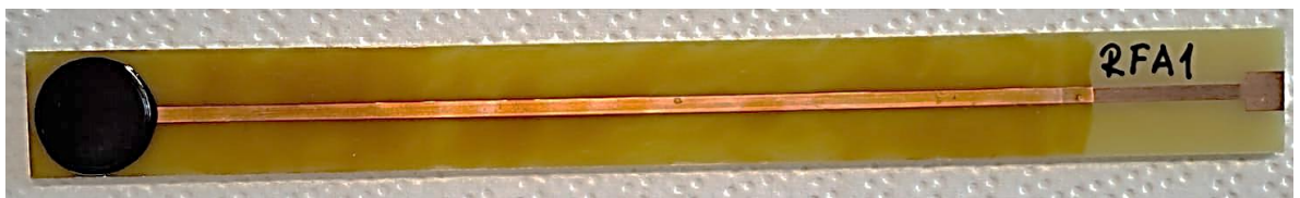
Slika 21. Elektroda spremna za mjerenje
