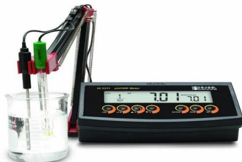
**Slika 17.** Određivanje pH vrijednosti pomoću digitalnog pH-metra
