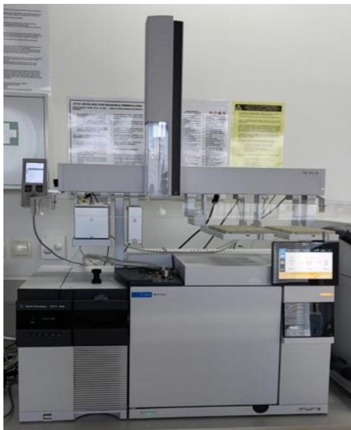
Slika 18. Prikaz korištenog GC-MS sustava
