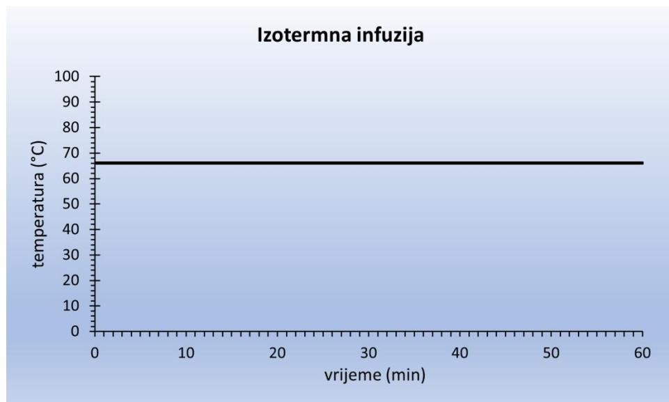
Slika 21. Grafički prikaz izotermne infuzije tijekom postupka ukomljavanja
