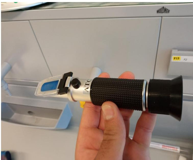
**Slika 13.** Određivanje sadržaja šećera refraktometrom
