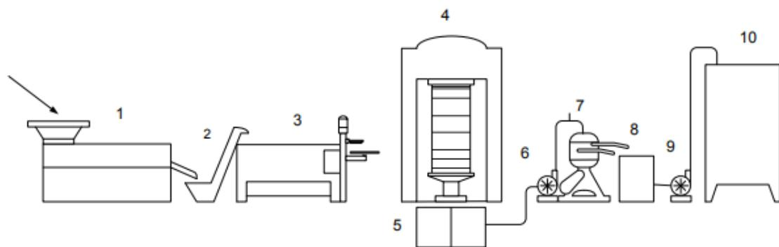
1 - Uredaj za pranje maslina, 2 - Kosi transporter, 3 - Uredaj za drobljenje, mljevenje i doziranje tijesta, 4 - Hidraulička preša, 5 - Prihvativi spremnik, 6 - Pumpa za ulje, 7 - Centrifugalni separator, 8 - Prihvativi spremnik za maslinovo ulje, 9 - Pumpa za ulje, 10 - Spremnik za skladištenje ulja.
