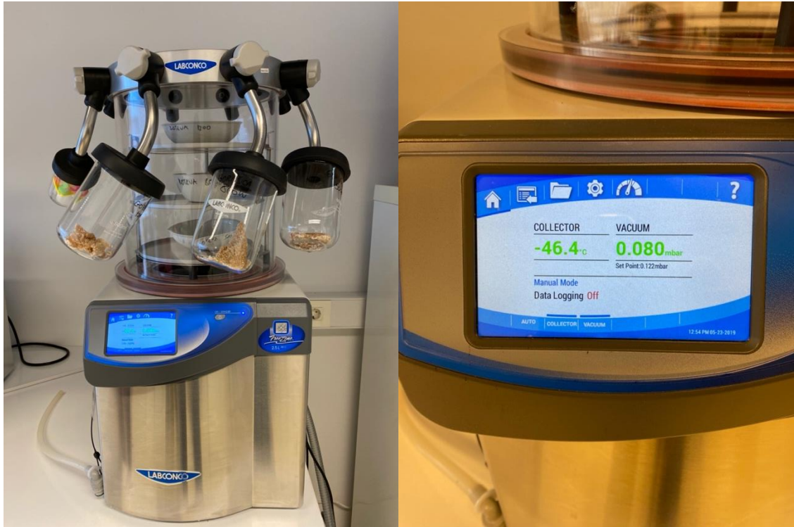
Slika 14. Liofilizacija uzoraka bijele gorušice i daikona
