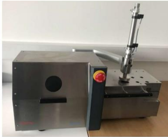
Slika 6. Laboratorijski dvopužni ekstruder HAAKE MiniLab 3
