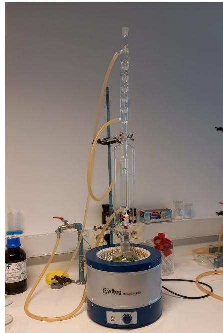
**Slika 2.6.** Modificirana aparatura za vodenu destilaciju po Clevengeru
