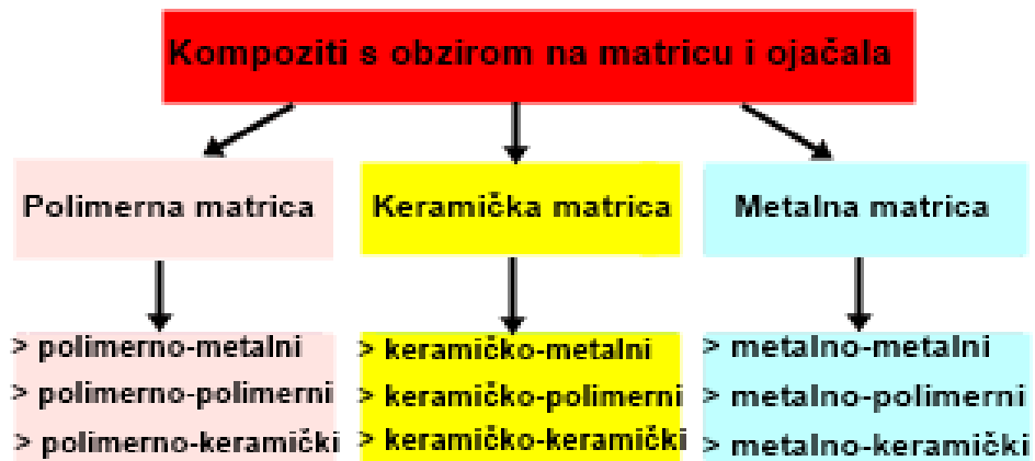
SLIKA 4. Podjela kompozita s obzirom na matricu i ojačala 12
