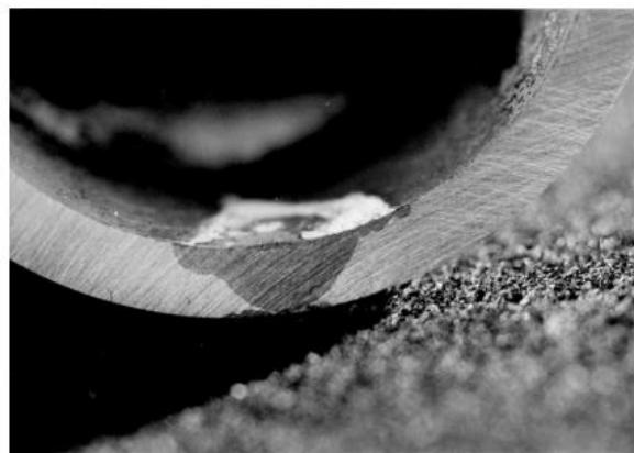
**Slika 17.** Primjer selektivne korozije.<sup>1</sup>
