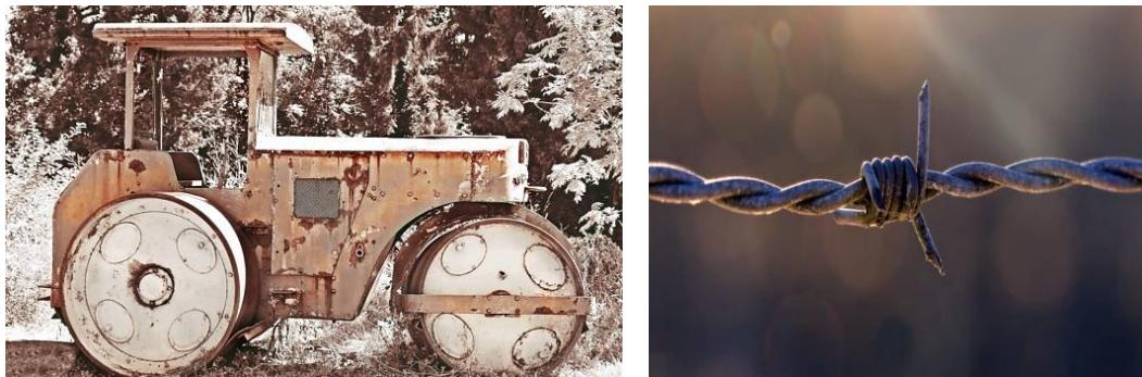
*Slika 3. Stari traktor napravljen od čelika ili bodljikava žica od metala koji su dugotrajno izloženi atmosferskim uvjetima poput kiše, snijega i vlage korodiraju.<sup>5,6</sup>*
