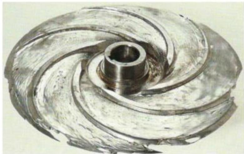
*Slika 13. Erozija-korozija.*<sup>10</sup>
