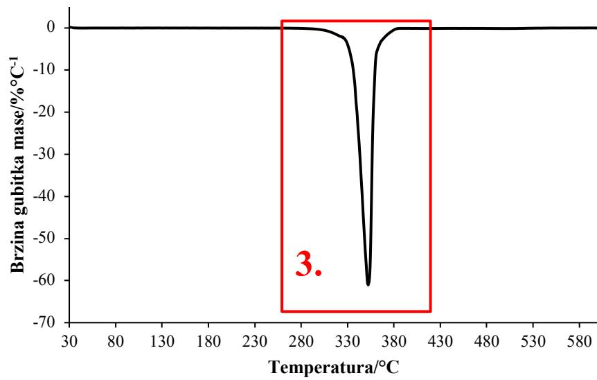
**Slika 17.** DTG krivulja neizotermne toplinske razgradnje mješavine 100PLA/0NaAlg
