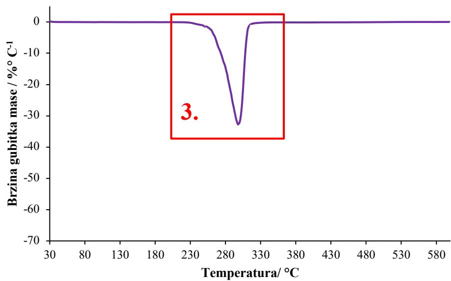
**Slika 21.** DTG krivulja neizotermne toplinske razgradnje mješavine 92PLA/8NaAlg
