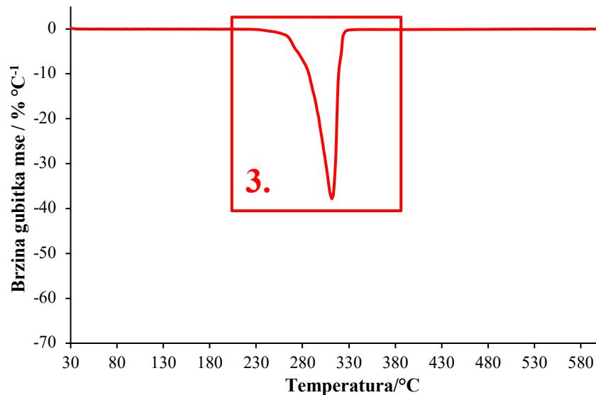
Slika 19. DTG krivulja neizotermne toplinske razgradnje mješavine 96PLA/4NaAlg
