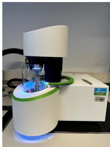
**Slika 12.** Termogravimetar TGA 8000
