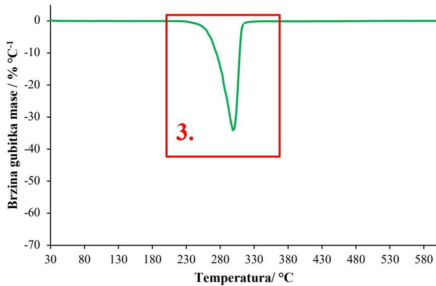
Slika 20. DTG krivulja neizotermne toplinske razgradnje mješavine 94PLA/6NaAlg
