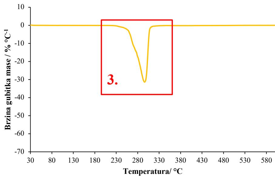
**Slika 22.** DTG krivulja neizotermne toplinske razgradnje mješavine 90PLA/10NaAlg
