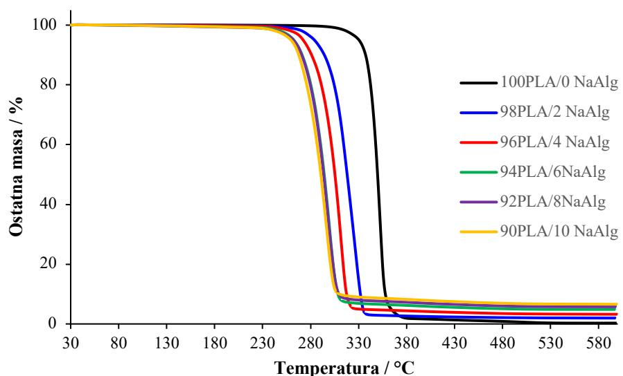
Slika 16. TG krivulje neizotermne toplinske razgradnje mješavina PLA/NaAlg
