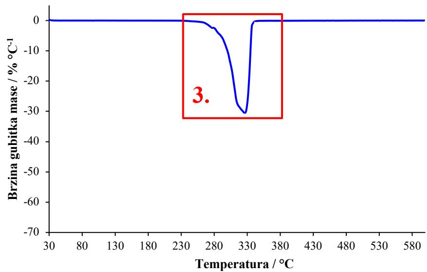
**Slika 18.** DTG krivulja neizotermne toplinske razgradnje mješavine 98PLA/2NaAlg
