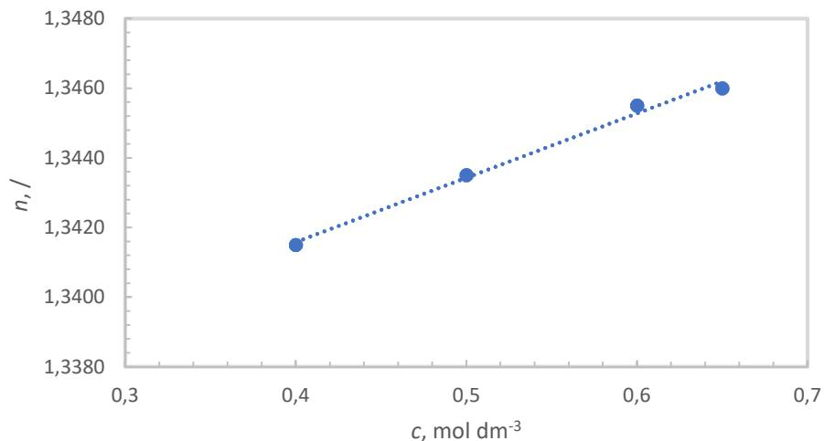
**Slika 20.** Ovisnost indeksa loma o koncentraciji otopine  $\text{K}_2\text{SO}_4$  pri  $T = 15^\circ\text{C}$ .
