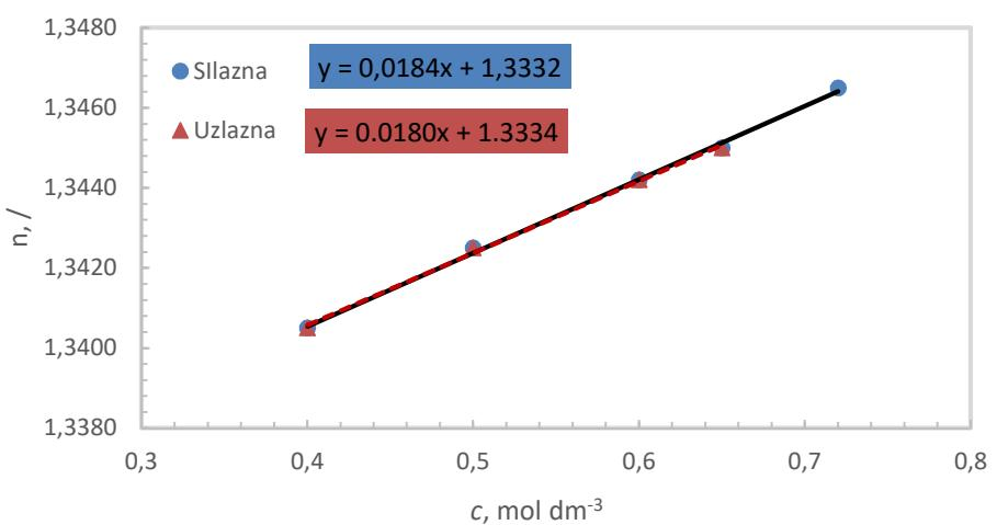
**Slika 23.** Baždarni pravci za silazno i uzlazno mijenjanje temperature pri  $T = 25^\circ\text{C}$ .
