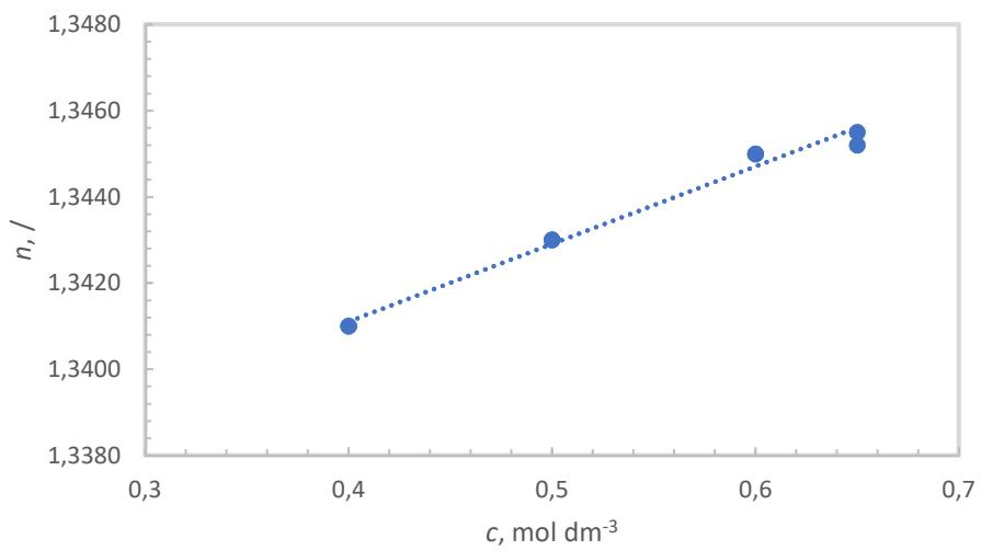
**Slika 19.** Ovisnost indeksa loma o koncentraciji otopine  $\text{K}_2\text{SO}_4$  pri  $T = 20^\circ\text{C}$ .
