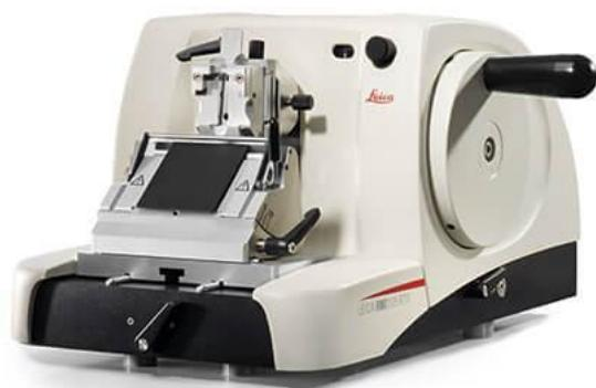
**Slika 15.** Mikrotom za precizno rezanje uzoraka<sup>63</sup>
