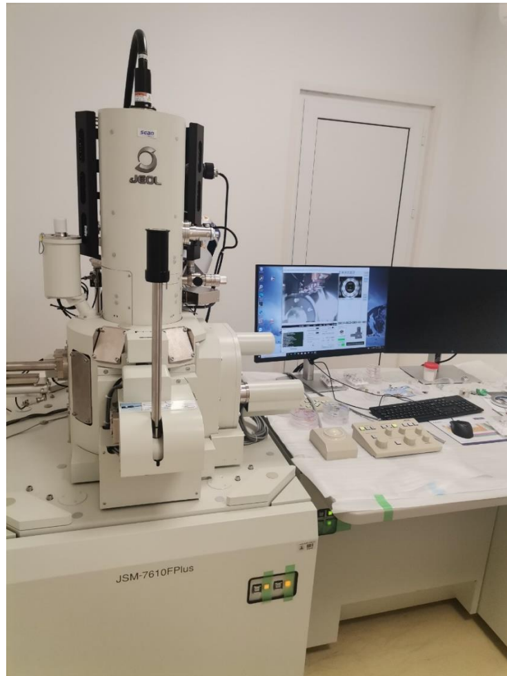
Slika 17. Skenirajući elektronski mikroskop
