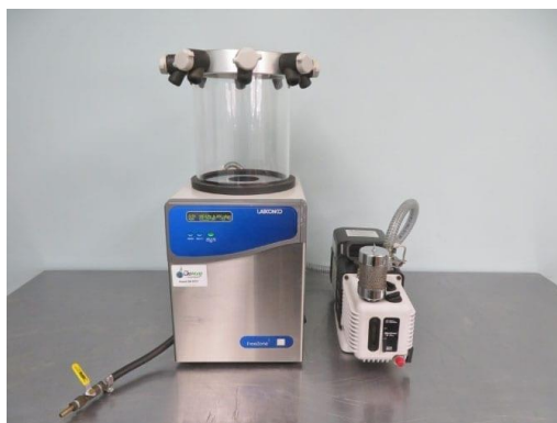
Slika 11. Uređaj za liofilizaciju 58
