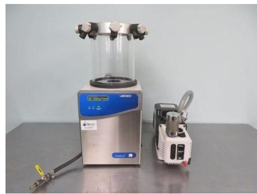
**Slika 11.** Uređaj za liofilizaciju<sup>58</sup>
