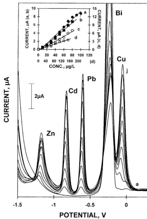
**Slika 11.** Voltamogram sa kvadratnom promjenom potencijala za rastuće koncentracije: bakra, olova, kadmija i cinka. Isječak: Odgovarajući kalibracijski graf kroz dato područje  $10\text{--}100 \mu\text{g/l}$  olova (a),  $10\text{--}80 \mu\text{g/l}$  bakra (b),  $10\text{--}70 \mu\text{g/l}$  kadmija (c), i  $20\text{--}120 \mu\text{g/l}$  cinka (d).<sup>22</sup>
