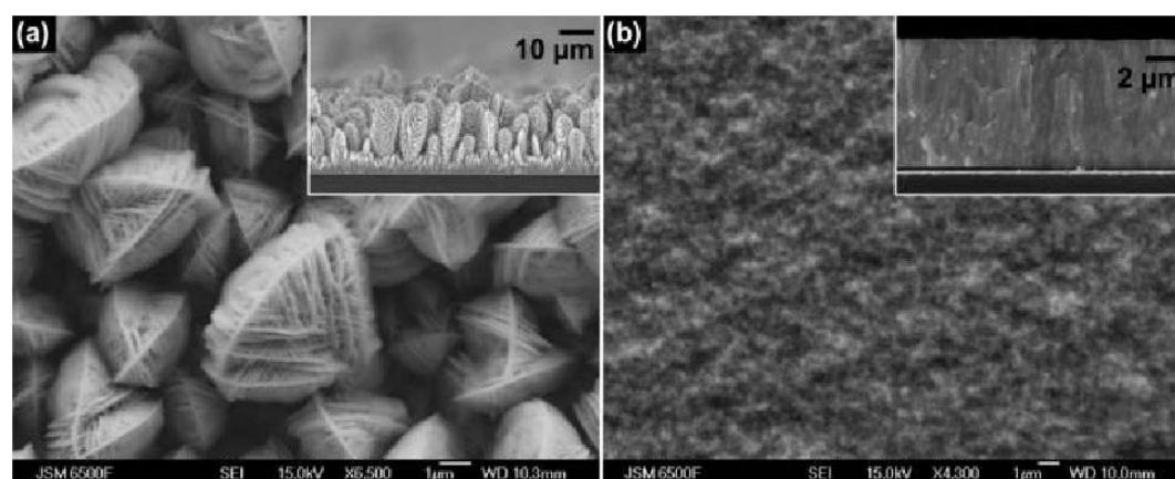
**Slika 13.** SEM snimke BiF elektrode dobivene elektodepozicijom bez (lijevo) i uz dodatak natrijeva lignosulfonata kao kompleksirajućeg reagensa.<sup>25</sup>
