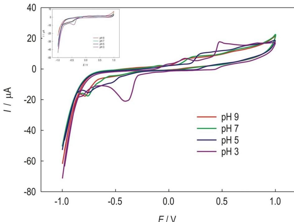
**Slika 31.** Ciklički voltamogrami GC/SWCNT/ $\text{Bi}_2\text{O}_3$  pri različitom pH fosfatnog elektrolita uz brzinu promjene potencijala  $25 \text{ mV/s}$  uz dodatak galne kiseline,  $1 \times 10^{-4} \text{ mol dm}^{-3}$ . Isječak: GC/SWCNT bez analita.
