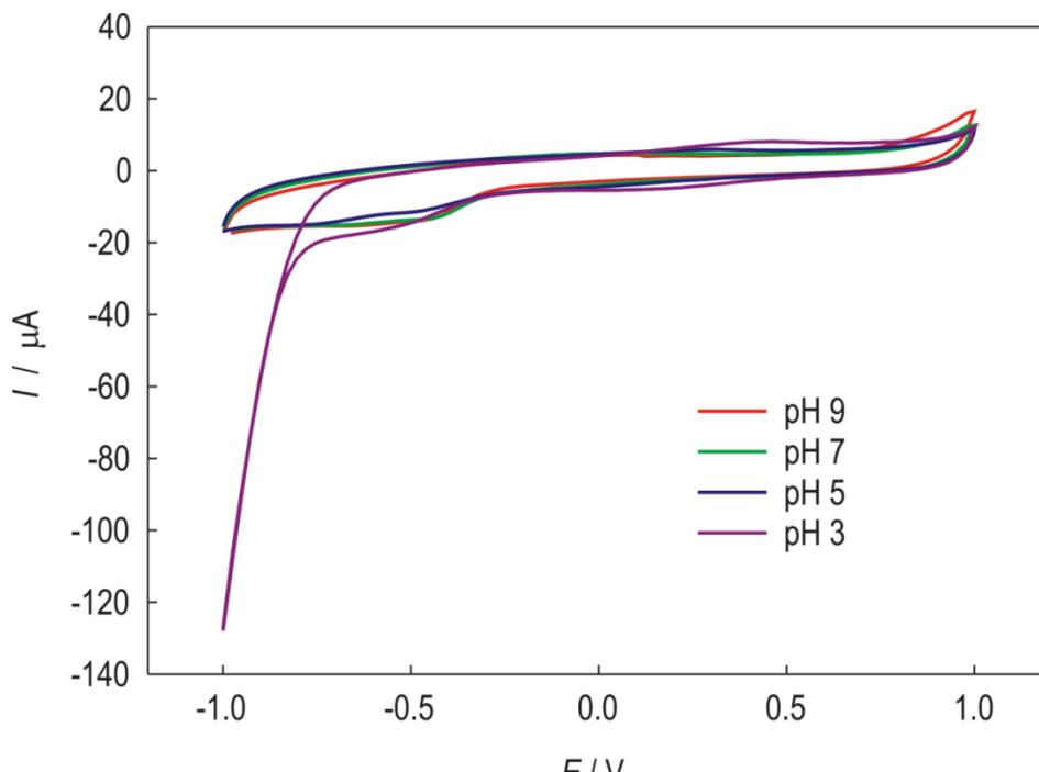
**Slika 22.** Ciklički voltamogrami GC/SWCNT pri različitom pH fosfatnog elektrolita uz brzinu promjene potencijala 25 mV/s.
