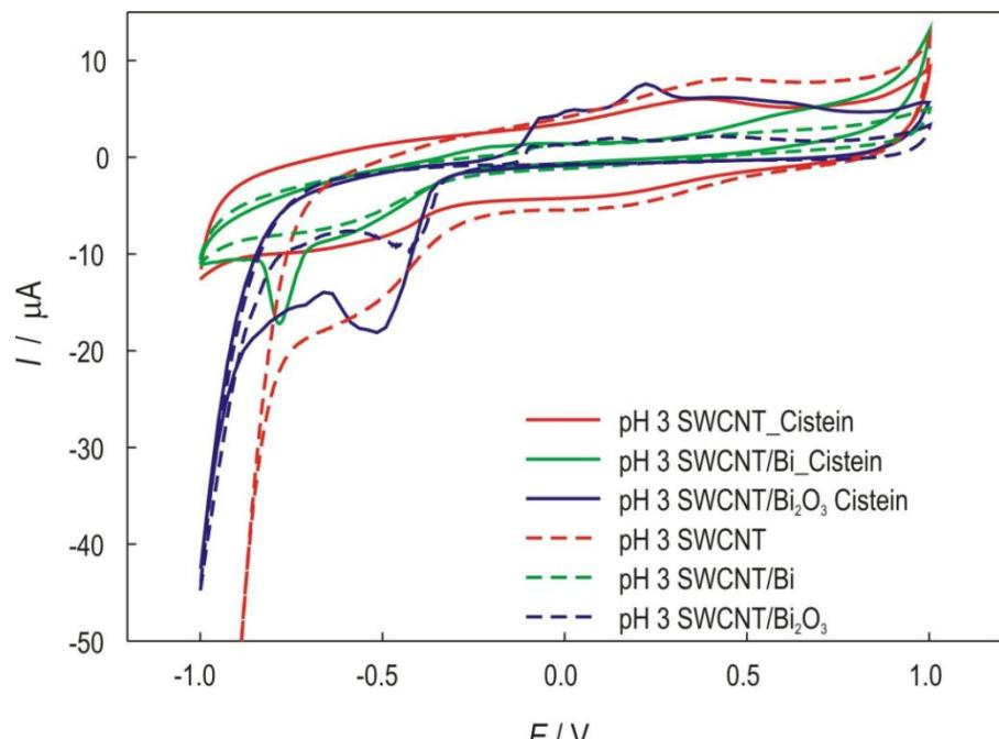
**Slika 37.** Usporedba svih pripravljenih elektroda prema cisteinu bez i uz dodatak cisteina,  $1 \times 10^{-4}$  mol dm $^{-3}$ .
