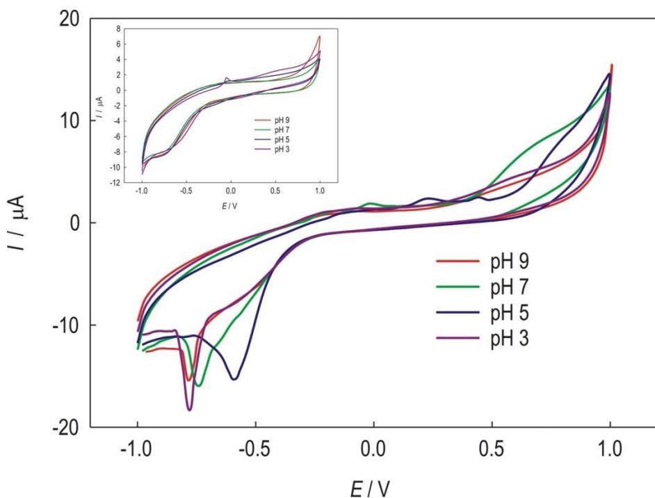
**Slika 33.** Ciklički voltamogrami GC/SWCNT/Bi pri različitom pH fosfatnog elektrolita uz brzinu promjene potencijala 25 mV/s uz dodatak cisteina,  $1 \times 10^{-4}$  mol dm $^{-3}$ . Isječak: GC/SWCNT bez analita.
