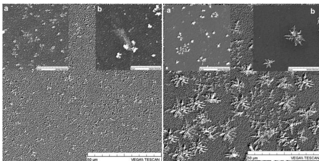
**Slika 12.** SEM snimke BiF elektrode dobivene elektodepozicijom iz otopine acetatnog pufera bez (lijevo) i uz dodatak EDTA kao kompleksirajućeg reagensa.<sup>24</sup>
