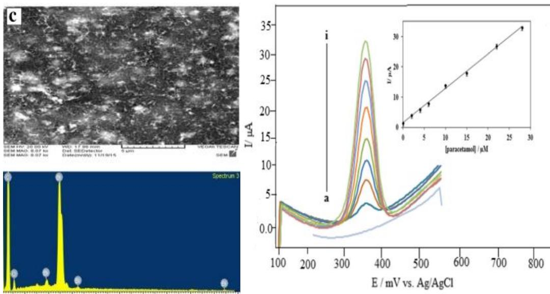
**Slika 14.** Lijevo – SEM – EDS analiza MWCNT uz dodatak  $\text{Bi}_2\text{O}_3$ , te desno – Voltamogram sa kvadratnom promjenom potencijala za rastuće koncentracije paracetamola s odgovarajućom krivuljom umjeravanja.<sup>28</sup>
