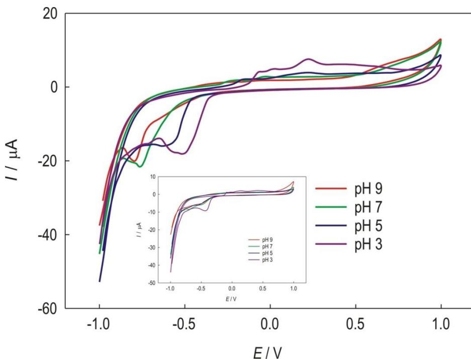
**Slika 34.** Ciklički voltamogrami GC/SWCNT/Bi<sub>2</sub>O<sub>3</sub> pri različitom pH fosfatnog elektrolita uz brzinu promjene potencijala 25 mV/s uz dodatak cisteina,  $1 \times 10^{-4}$  mol dm<sup>-3</sup>. Isječak: GC/SWCNT bez analita.
