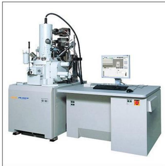
**Slika 4.** Pretražni elektroniski mikroskop.<sup>10</sup>
