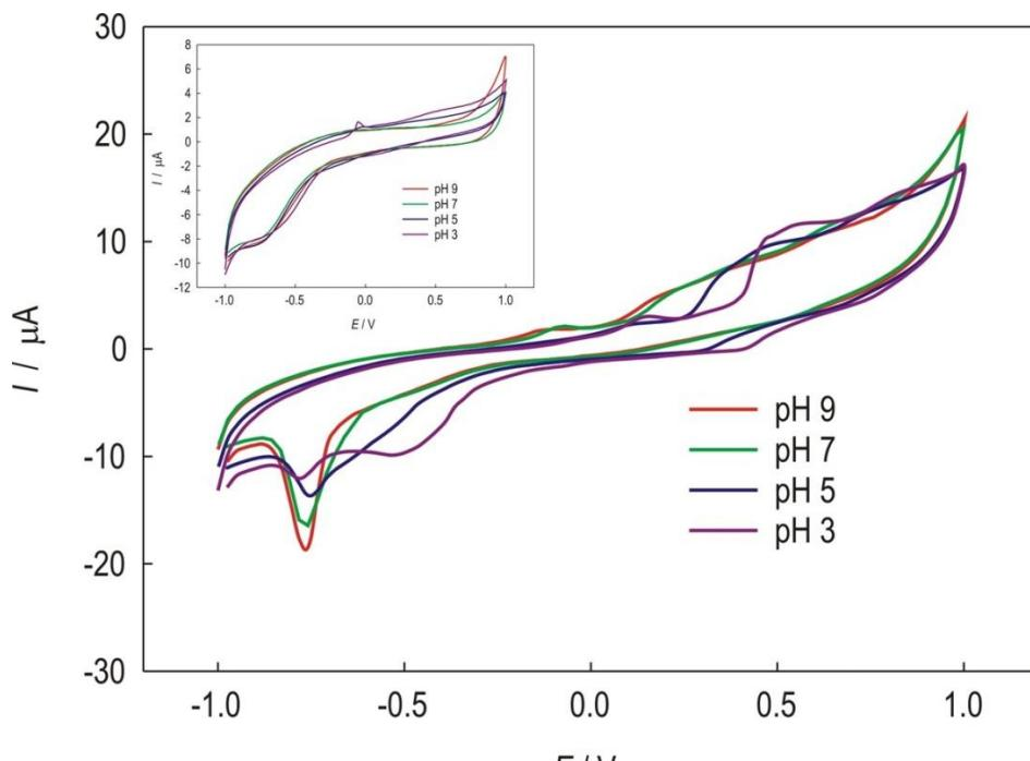
**Slika 30.** Ciklički voltamogrami GC/SWCNT/Bi pri različitom pH fosfatnog elektrolita uz brzinu promjene potencijala  $25 \text{ mV/s}$  uz dodatak galne kiseline,  $1 \times 10^{-4} \text{ mol dm}^{-3}$ .
