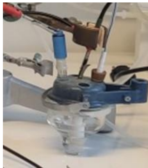
Slika 19. Troelektrodna ćelija za elektrokemijska mjerenja.
