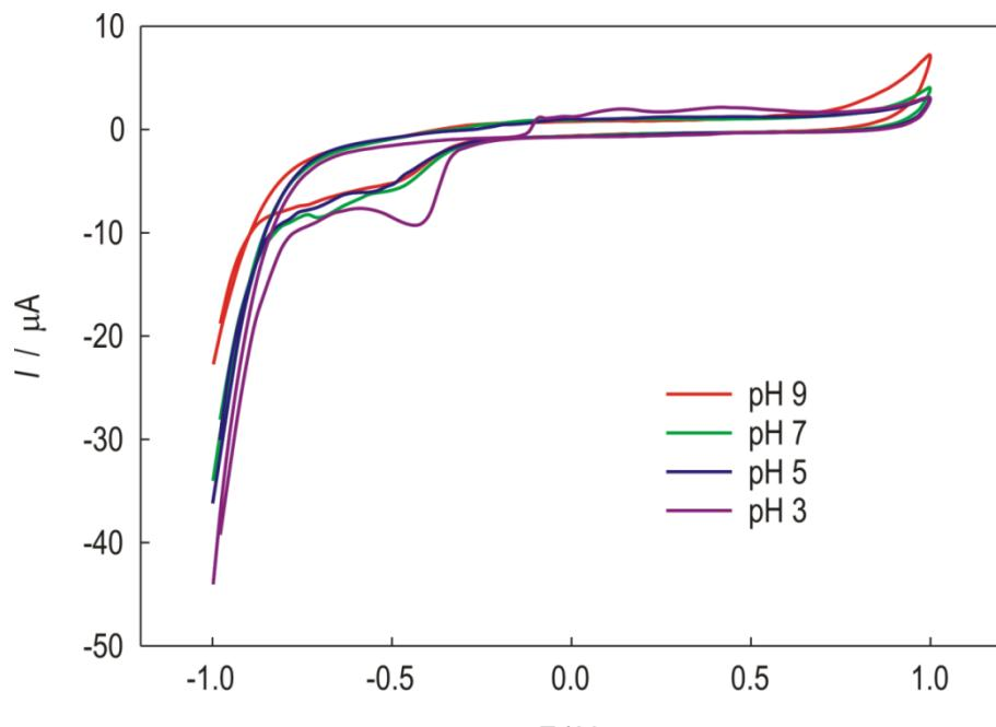
**Slika 24.** Ciklički voltamogrami GC/SWCNT/ $\text{Bi}_2\text{O}_3$  pri različitom pH fosfatnog elektrolita uz brzinu promjene potencijala 25 mV/s.
