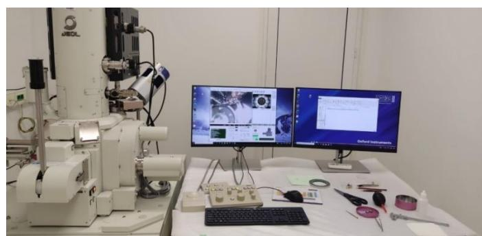
Slika 20. SEM/EDS JEOL JSM – 7610F Plus.
