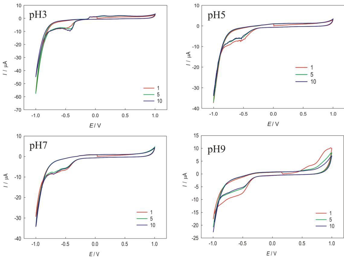
**Slika 26.** Ciklički voltamogrami ovisnosti broja ciklusa za GC/SWCNT/ $\text{Bi}_2\text{O}_3$  pri različitom pH fosfatnog elektrolita uz brzinu promjene potencijala 25 mV/s; 1. 5. i 10. ciklus.
