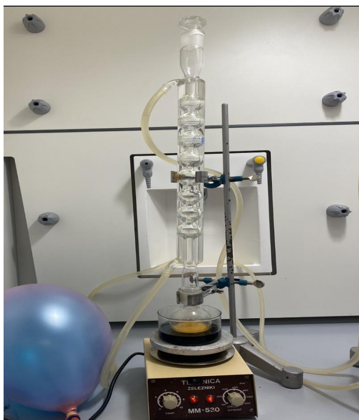
Slika 7. Zagrijavanje u uljnoj kupelji.
