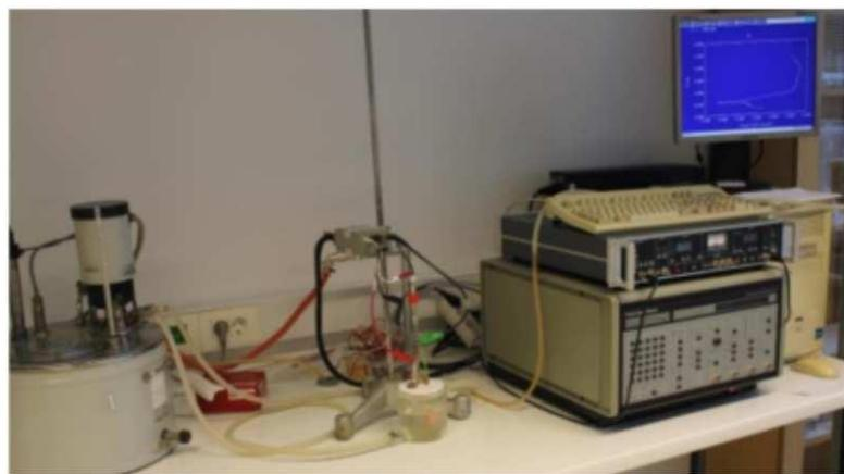
**Slika 12.** Potencijostat/galvanostat PAR 273A povezan s elektrodama u elektrokemijskoj čeliji
