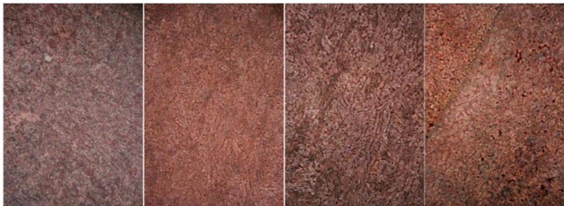
**Slika 28.** Površina CuZnPb uzorka nakon PD mjerena u mirujućoj morskoj vodi različitim temperaturama: a)  $T= 10^{\circ}\text{C}$ , b)  $T= 20^{\circ}\text{C}$ , c)  $T= 30^{\circ}\text{C}$ , d)  $T= 40^{\circ}\text{C}$
