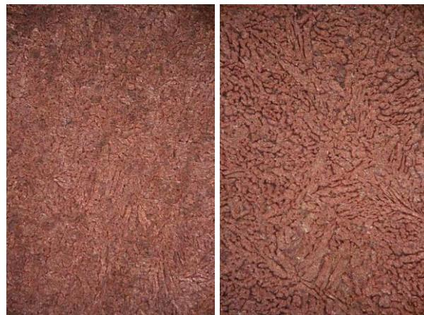
**Slika 27.** Površina CuZnPb uzorka nakon PD mjerena u morskoj vodi pri  $T=20^{\circ}\text{C}$ : a) u mirujućoj otopini, b) uz miješanje magnetskom miješalicom  $200 \text{ o min}^{-1}$
