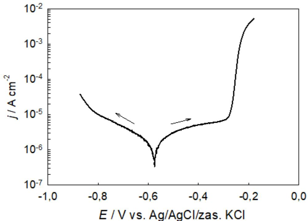
**Slika 4.1.** Struja-potencijal karakteristike Sn elektrode u  $0,1 \text{ mol dm}^{-3}$  otopini  $\text{NaCl}$  snimljene u širokom području potencijala oko koroziskog potencijala.
