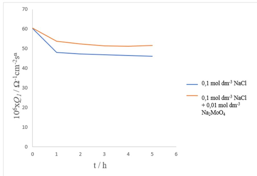
**Slika 4.1.** Ovisnost koeficijenta konstantno faznog elementa  $Q_1$  o vremenu, tijekom boravka Sn elektrode u  $0,1 \text{ mol dm}^{-3}$  otopini NaCl i u  $0,01 \text{ mol dm}^{-3}$  otopini  $\text{Na}_2\text{MoO}_4$  u  $0,1 \text{ mol dm}^{-3}$  otopini NaCl.
