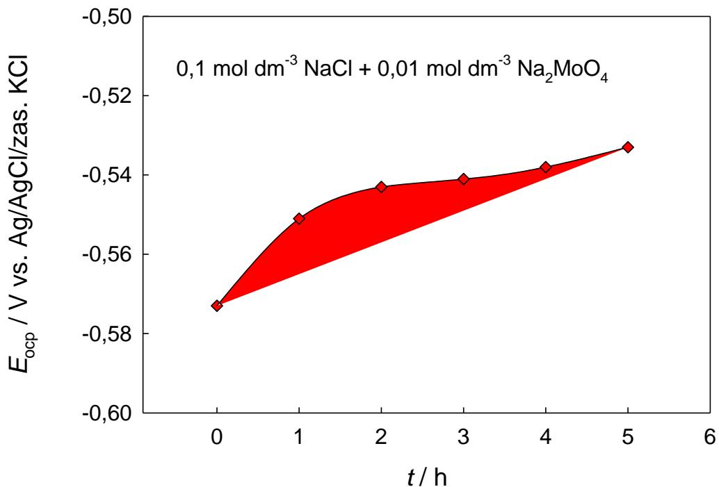
**Slika 3.2.** Ovisnost potencijala otvorenog strujnog kruga  $E_{\text{ocp}}$  elektrode Sn u  $0,01 \text{ mol dm}^{-3}$  otopini  $\text{Na}_2\text{MoO}_4$  u  $0,1 \text{ mol dm}^{-3}$  otopini  $\text{NaCl}$ .
