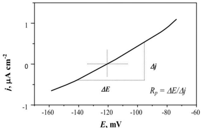
**Slika 1.2.** Određivanje polarizacijskog otpora.<sup>11</sup>
