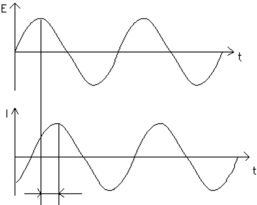
Slika 1.3. Prikaz promjene izmjenične struje i potencijala s vremenom
