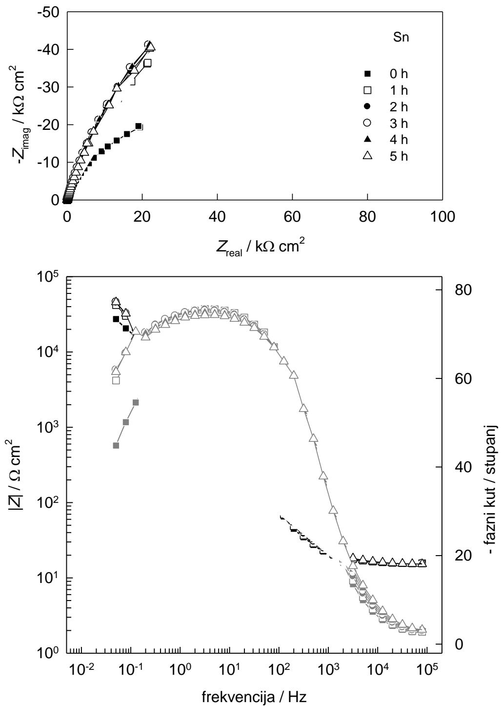
**Slika 3.8.** Nyquistov i Bodeov prikaz elektrokemijskih impedancijskih spektara Sn elektrode tijekom boravka u  $0,01 \text{ mol dm}^{-3}$  otopini  $\text{Na}_2\text{MoO}_4$  u  $0,1 \text{ mol dm}^{-3}$  otopini  $\text{NaCl}$  na potencijalu otvorenog strujnog kruga. Vrijeme boravka elektrode u elektrolitu prikazano je na detalju Nyquistovog prikaza.
