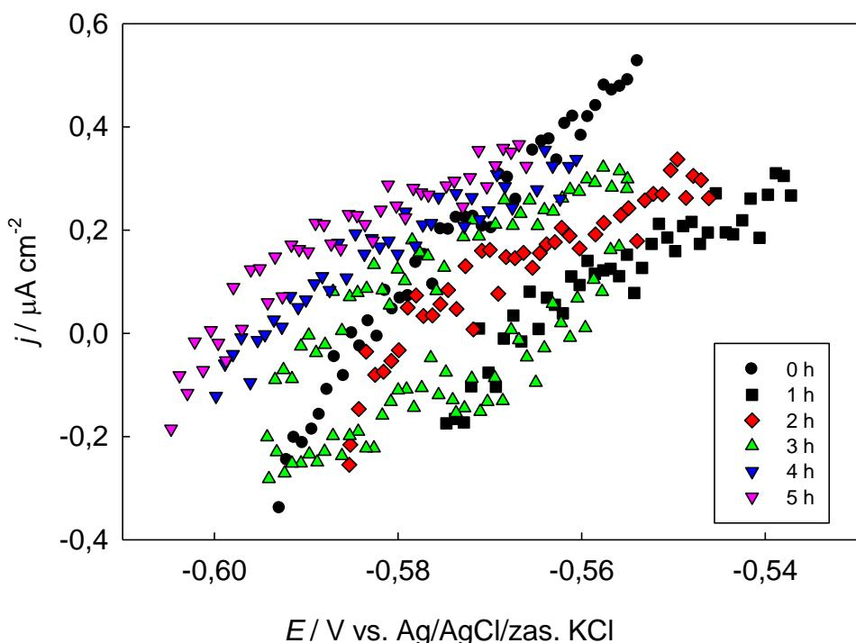
**Slika 3.5.** Struja - potencijal karakteristike Sn elektrode tijekom boravka u  $0,1 \text{ mol dm}^{-3}$  otopini NaCl na potencijalima  $\pm 10$  mV vs.  $E_{\text{oCP}}$  snimljene brzinom promjene potencijala od  $1 \text{ mV s}^{-1}$ . Vrijeme boravka u elektrolitu prikazano je na detalju slike.
