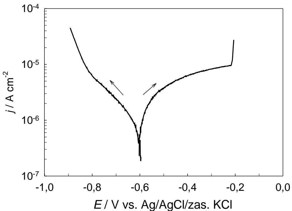
**Slika 4.2.** Struja-potencijal karakteristike Sn elektrode u  $0,01 \text{ mol dm}^{-3}$  otopini  $\text{Na}_2\text{MoO}_4$  u  $0,1 \text{ mol dm}^{-3}$  otopini  $\text{NaCl}$  snimljene u širokom području potencijala oko koroziskog potencijala.
