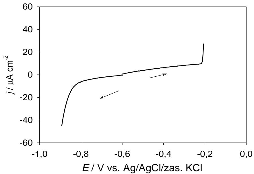
**Slika 3.4.** Katodna i anodna linearna polarizacijska krivulja elektrode Sn u  $0,01 \text{ mol dm}^{-3}$  otopini  $\text{Na}_2\text{MoO}_4$  u  $0,1 \text{ mol dm}^{-3}$  otopini  $\text{NaCl}$  snimljena brzinom promjene potencijala  $v = 2 \text{ mV s}^{-1}$ . Krivulje su snimljene polazeći od potencijala otvorenog strujnog kruga.
