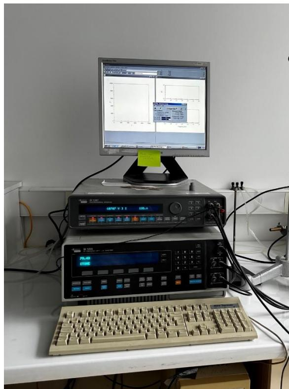
**Slika 2.3.** Aparatura korištena za korozionska mjerena
