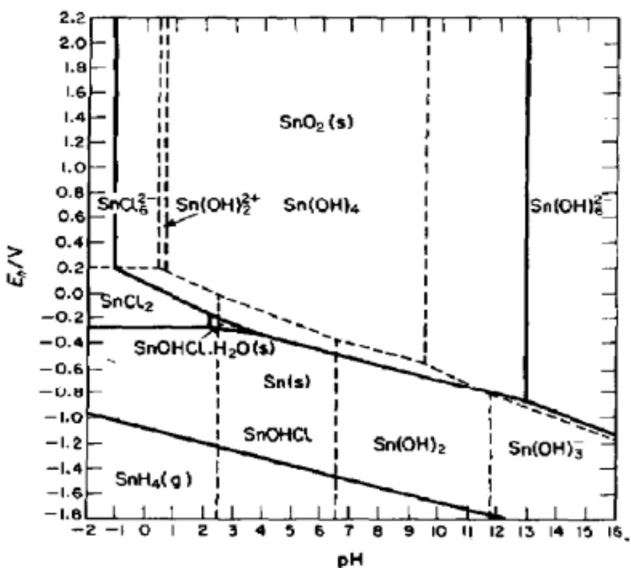
**Slika 1.3.** Pourbaixov dijagram za kositar u otopini kloridnih iona koncentracije  $1.00 \text{ mol dm}^{-3}$  pri  $25^\circ\text{C}$ .<sup>6</sup>
