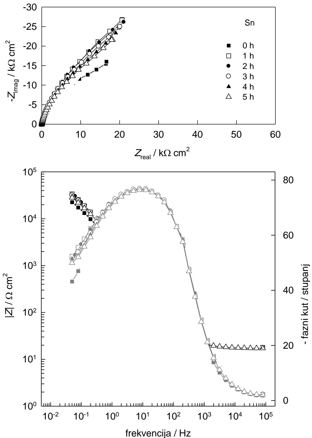
**Slika 3.7.** Nyquistov i Bodeov prikaz elektrokemijskih impedancijskih spektara Sn elektrode tijekom boravka u  $0,1 \text{ mol dm}^{-3}$  otopini NaCl na potencijalu otvorenog strujnog kruga. Vrijeme boravka elektrode u elektrolitu prikazano je na detalju Nyquistovog prikaza.
