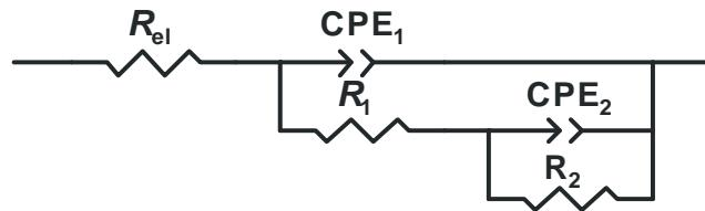
**Slika 4.3.** Ekvivalentni električni krug korišten za matematičko usklađivanje eksperimentalno dobivenih elektrokemijskih impedancijskih spektara.
