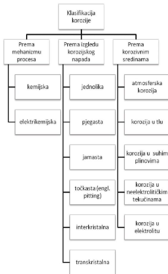
Slika 1.1. Klasifikacija korozije<sup>12</sup>
