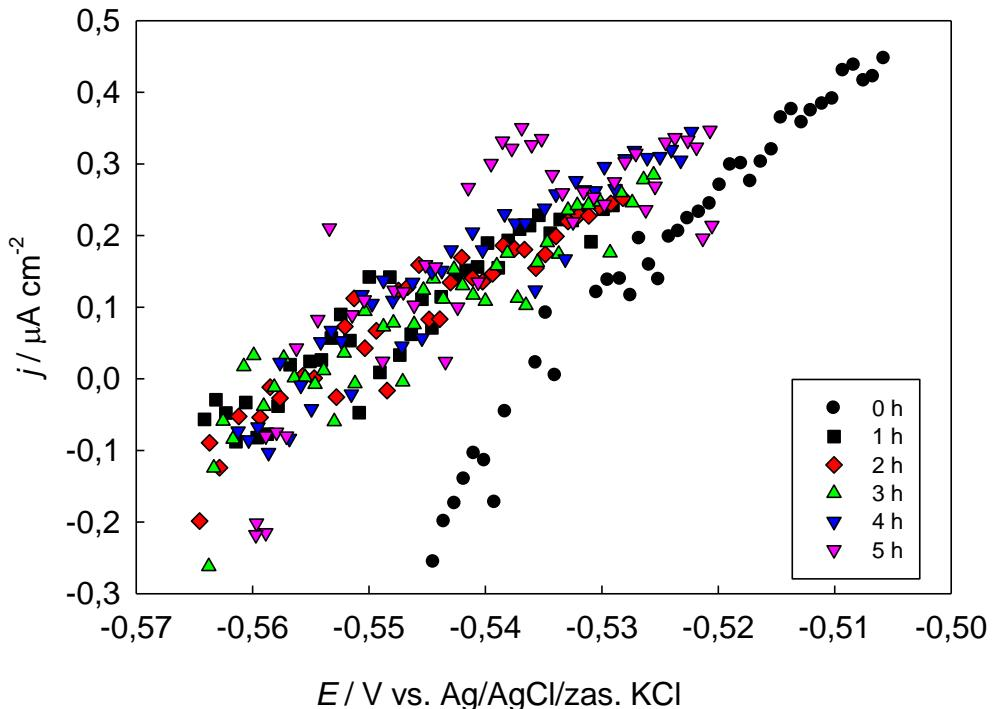
**Slika 3.6.** Struja - potencijal karakteristike Sn elektrode tijekom boravka u  $0,01 \text{ mol dm}^{-3}$  otopini  $\text{Na}_2\text{MoO}_4$  u  $0,1 \text{ mol dm}^{-3}$  otopini  $\text{NaCl}$  na potencijalima  $\pm 10 \text{ mV}$  vs.  $E_{\text{ocp}}$  snimljene brzinom promjene potencijala od  $1 \text{ mV s}^{-1}$ . Vrijeme boravka u elektrolitu prikazano je na detalju slike.
