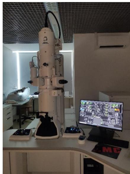
**Slika 17.** Jeol JEM 1400Flash elektronski mikroskop
