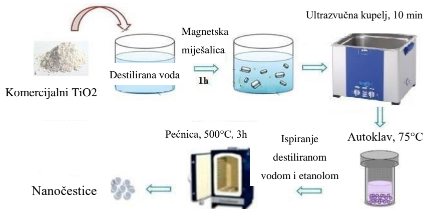
Slika 9. Primjer sinteze nanostrukturiranog \text{TiO}_2 hidrotermalnom metodom 25
