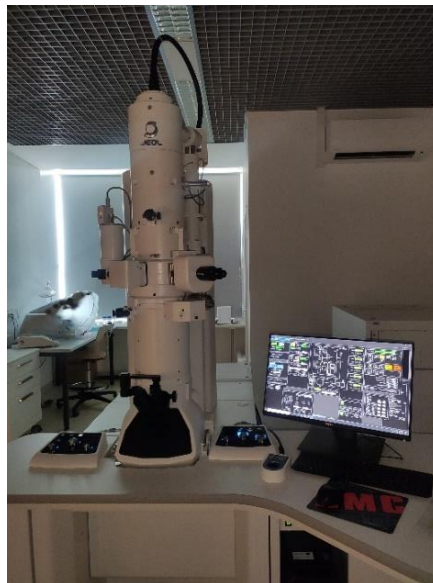
Slika 17. Jeol JEM 1400Flash elektronski mikroskop
