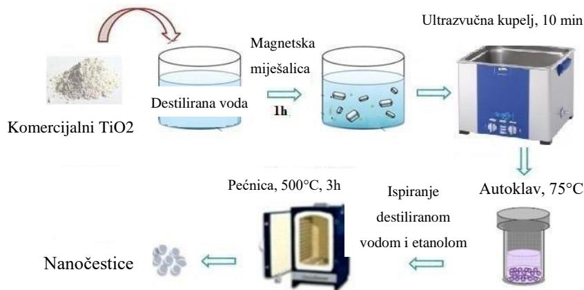
**Slika 9.** Primjer sinteze nano strukturiranog  $\text{TiO}_2$  hidrotermalnom metodom<sup>25</sup>
