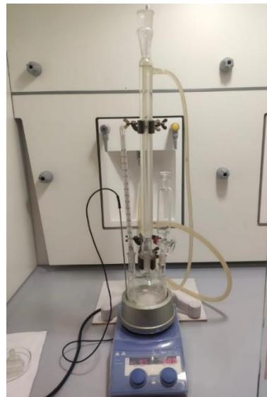
**Slika 11.** Prikaz aparature pod refluksom pri 85°C
