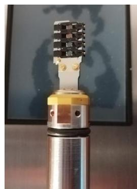
**Slika 19.** Nosač uzorka (pripremljenih mrežica) za snimanje na TEM-u
