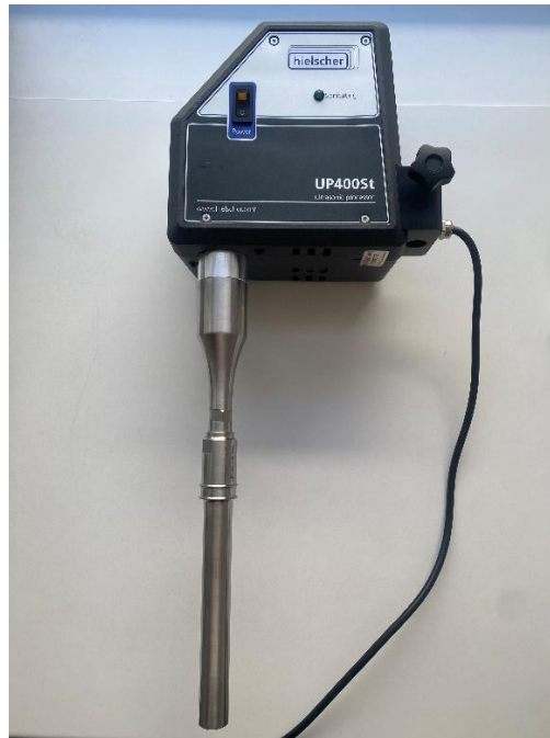
Slika 15. Ultrazvučni homogenizator Hielscher UP400St.
