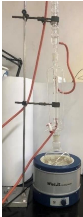
Slika 3. Aparatura po Clevengeru
