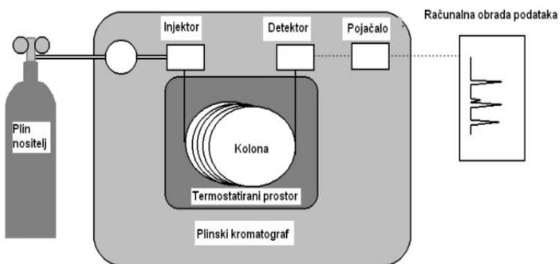
Slika 9. Shematski prikaz plinskog kromatografa
