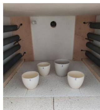
**Slika 10.** Uzorci u peći za kalciniranje
