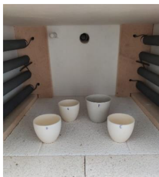
Slika 10. Uzorci u peći za kalciniranje
