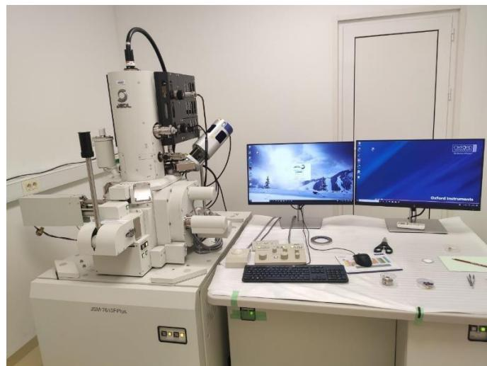
**Slika 13.** Jeol JEM -7610F Plus pretražni elektronski mikroskop
