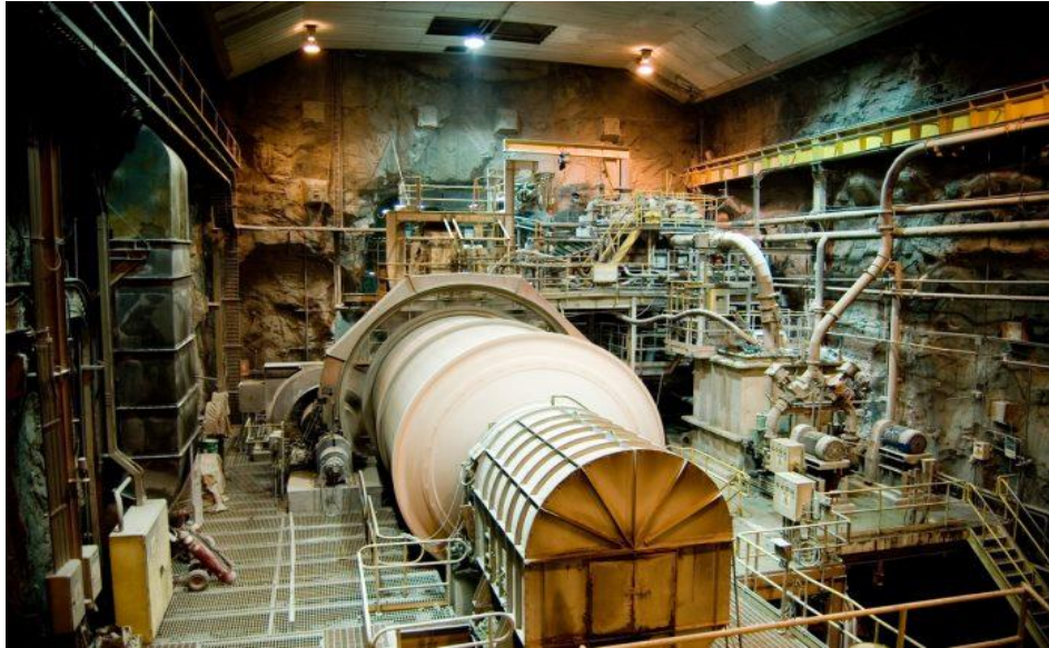
Slika 2. Postrojenje za proces usitnjavanja u kemijskoj industriji.
