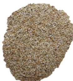
Slika 2.1. Fotografija uzorka prirodnog zeolita klinoptilolita.
