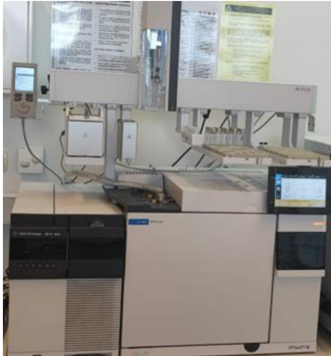
Slika 11. Plinska kromatografija sa spektrometrijom masa (GC-MS)
