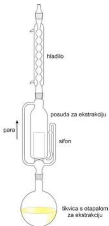
Slika 5. Soxhletov ekstraktor
