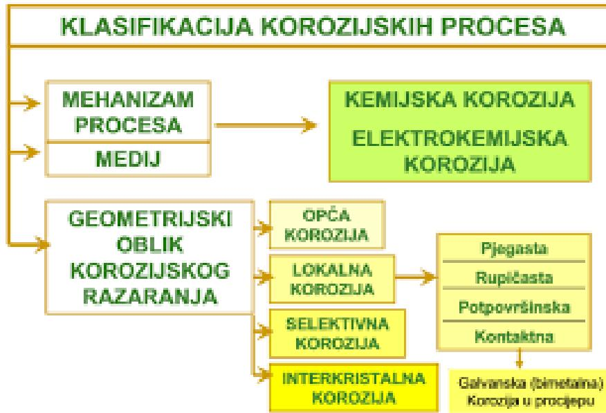
Slika 1.5. Shematski prikaz klasifikacije korozijskih procesa<sup>11</sup>
