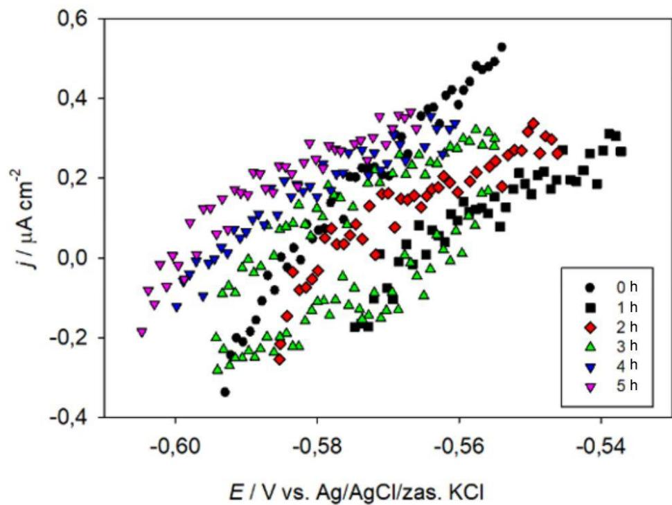
**Slika 3.4.** Struja - potencijal karakteristike Sn elektrode tijekom boravka u  $0,1 \text{ mol dm}^{-3}$  otopini NaCl u području potencijala  $\pm 15$  mV vs.  $E_{\text{ocp}}$ . Brzina promjene potencijala  $1 \text{ mV s}^{-1}$ .
