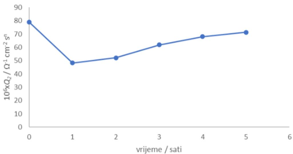
**Slika 4.8.** Ovisnost koeficijenta  $Q_2$  konstantno faznog elementa KFE<sub>2</sub> o vremenu tijekom boravka Sn elektrode u 0,1 mol dm<sup>-3</sup> otopini NaCl.
