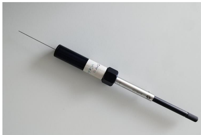
Slika 19. Uređaj za mikroekstrakciju (vlastita fotografija)
