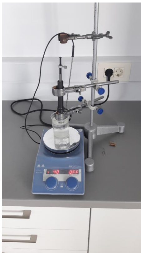
Slika 22. Mikroekstrakcija vršnih para na čvrstoj fazi (HS-SPME).
