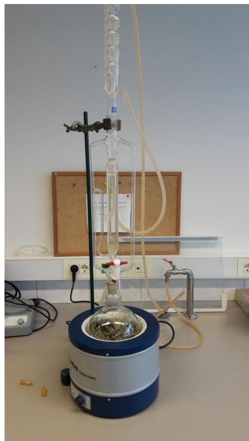
Slika 19. Aparatura za destilaciju po Clevengeru.
