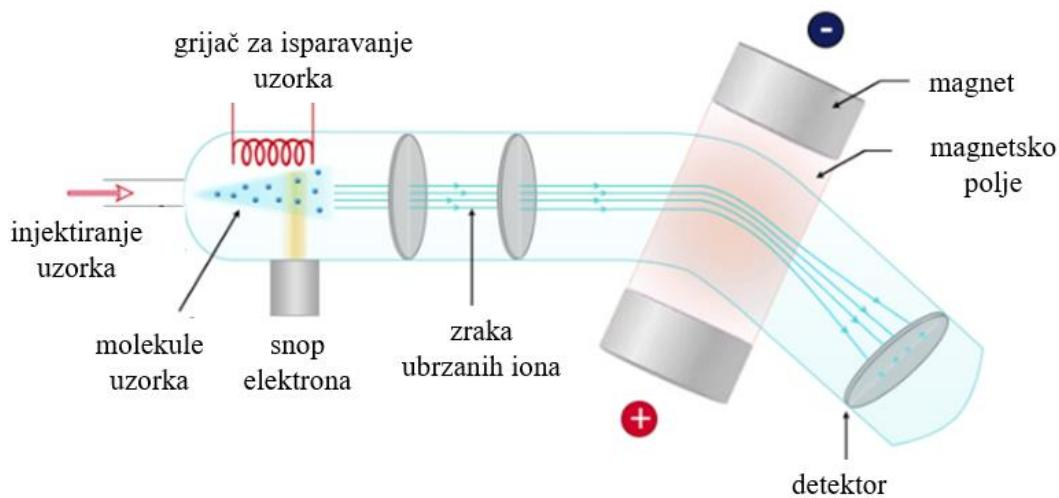
Slika 10. Shematski prikaz načina rada spektrometra masa.
