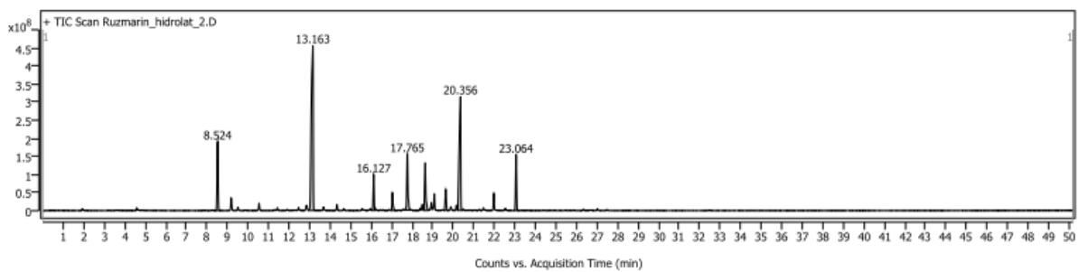
Slika 27. Kromatogram ukupne ionske struje hijidrolata ružmarina.
