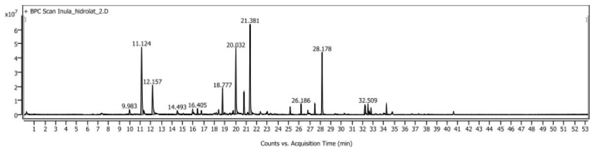
Slika 29. Kromatogram ukupne ionske struje hidrolata primorskog omana.
