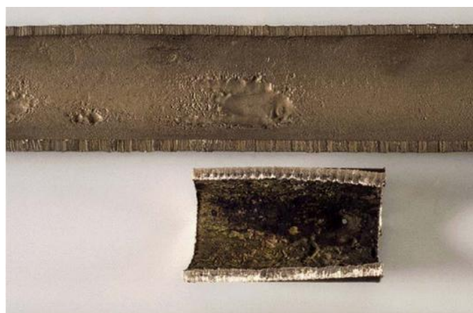
Slika 4. Erozijska korozija CuNi legure 25
