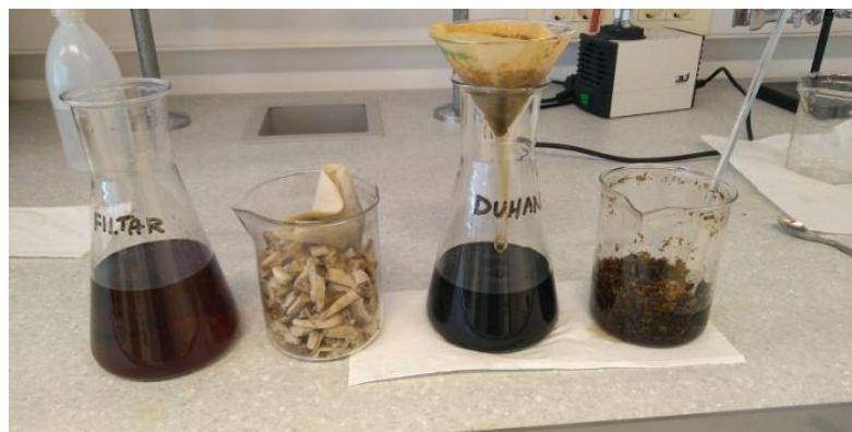
Slika 16. Priprava ekstrakta filtera (lijevo) i ekstrakta ostataka duhana (desno)
