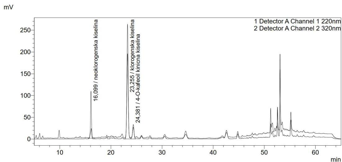
**Slika 19.** Ukupni ionski kromatogram ekstrakta lista iz Korčule analiziranog HPLC tehnikom, s karakterističnim retencijskim vremenima ( $RT_{\text{neoklorogenska kiselina}} = 16.099$ ,  $RT_{\text{klorogenska kiselina}} = 23.255$ ,  $RT_{\text{4-kafeoil kinična kiselina}} = 24.381$  min)
