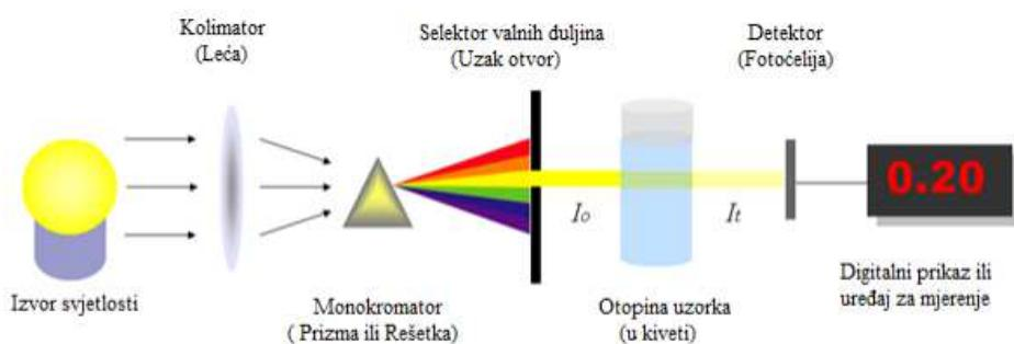
**Slika 8.** Shematski prikaz osnovnih dijelovi UV/Vis spektrofotometra<sup>23</sup>
