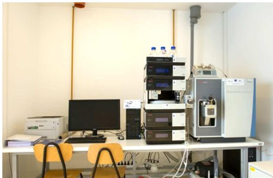
**Slika 13.** Tekućinski kromatogram<sup>31</sup>
