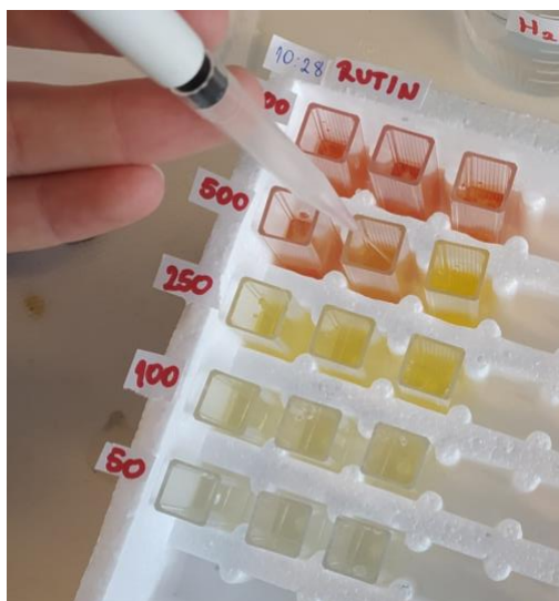
Slika 8. Priprema otopina rutina za izradu baždarne krivulje (vlastita fotografija)
