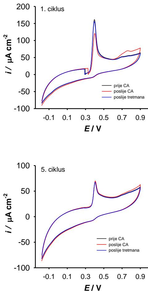
Slika 31. CV snimljeni u  $1 \times 10^{-4}$  M galnoj kiselini u 0,1 M B-R puferu na  $50 \text{ mV s}^{-1}$  prije CA mjerena, poslije CA mjerena te nakon tretmana čišćenja elektrode.
