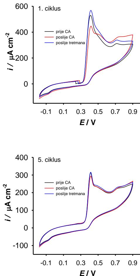
Slika 32. CV snimljeni u  $1 \times 10^{-3} M$  galnoj kiselini u  $0,1 M$  B-R puferu na  $50 mV s^{-1}$  prije CA mjerena, poslije CA mjerena te nakon tretmana čišćenja elektrode.
