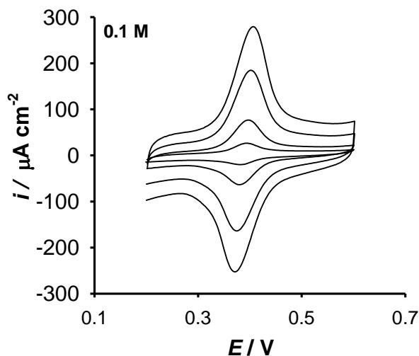
Slika 28. Utjecaj brzine posmika na reverzibilni signal unutar poroznog sloja pri koncentraciji B-R pufera 0,1 M. Brzine posmika: 25, 50, 100, 200, 300  $mV\ s^{-1}$ . Elektroda je čišćena za svaku brzinu posmika.
