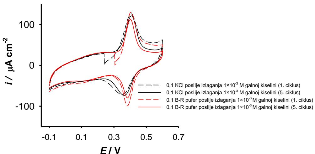
Slika 19. CV snimljeni u različitim otopinama ( $100 \text{ mV s}^{-1}$ ) nakon izlaganja galnoj kiselini. Elektroda je nakon opterećenja tretirana sa vodom uz miješanje (1 minut).
