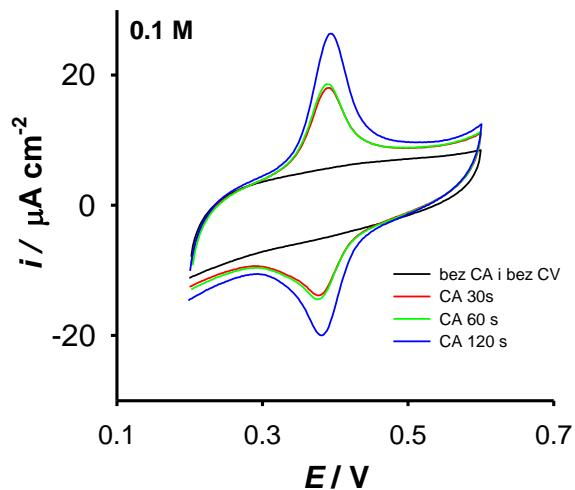
Slika 30. CV snimljeni na  $50 \text{ mV s}^{-1}$  u  $0,1 \text{ M}$  B-R puferu sa različitim vremenima elektrolize (CA). CA su snimljeni na  $0,4 \text{ V}$  ("kinetički dio") u  $1 \times 10^{-3} \text{ M}$  galnoj kiselini u  $0,1 \text{ M}$  B-R puferu.
