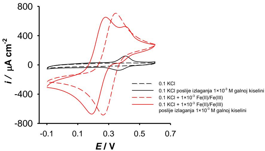
Slika 13. CV (5. ciklusi) snimljeni u različitim otopinama nakon izlaganja elektrode galnoj kiselini. CV su snimljeni pri  $100 \text{ mV s}^{-1}$ . Elektroda je nakon opterećenja tretirana s vodom uz miješanje (1 min).
