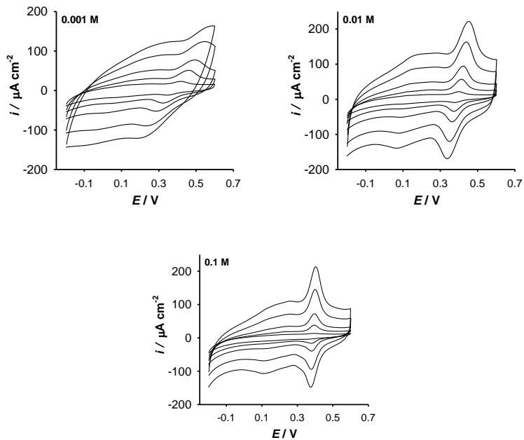
Slika 25. Utjecaj brzine posmika na reverzibilni signal unutar poroznog sloja pri različitim koncentracijama B-R pufera. Brzine posmika: 25, 50, 100, 200, 300 mV s<sup>-1</sup>.
