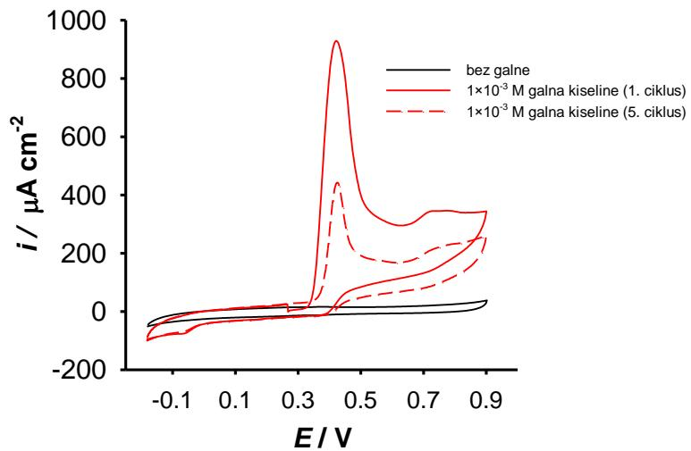
Slika 11. Ciklički voltamogrami (CV) snimljeni u Britton-Robinson puferu (pH 3,6,  $c=0,1\text{ M}$ ,  $v=50\text{ mV s}^{-1}$ ) bez i u prisutnosti galne kiseline.
