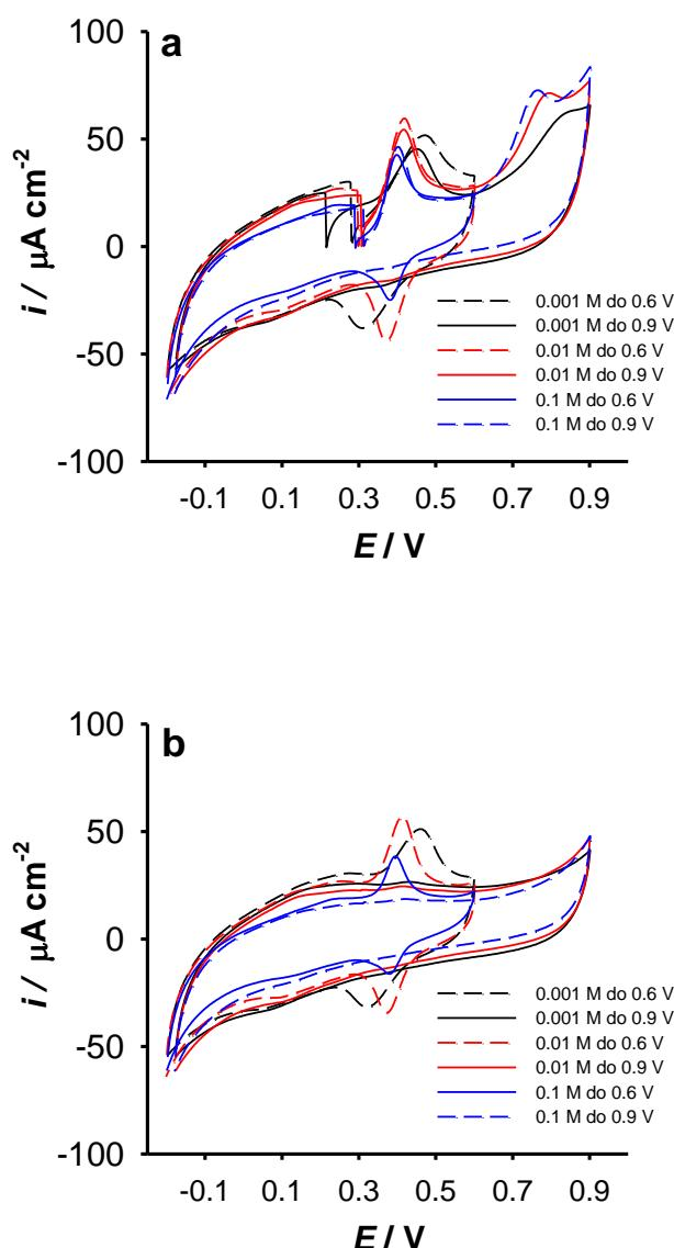
Slika 24. Utjecaj koncentracije B-R pufera i anodne granice na strujni odziv u poroznom sloju. (a) 1. ciklus; (b) 5. ciklus. Mjerjenja su rađena sa brzinom posmika od  $50 \text{ mV s}^{-1}$ . Prije mjerjenja, elektroda je bila tretirana u vodi, 1 minutu s miješanjem.
