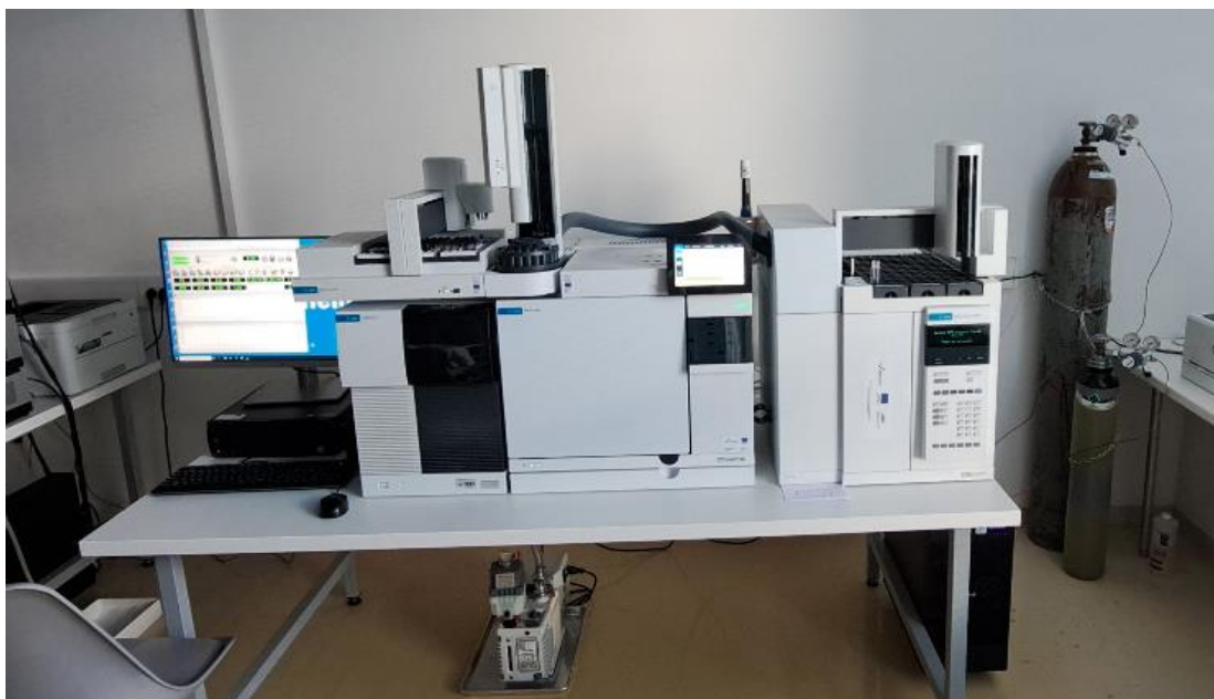
Slika 10. Plinski kromatograf sa spektrometrom masa s trostrukim kvadrupolom i automatskim uzorkivačem 8890 GC-7000D GC/TQ (Agilent Technologies, SAD)
