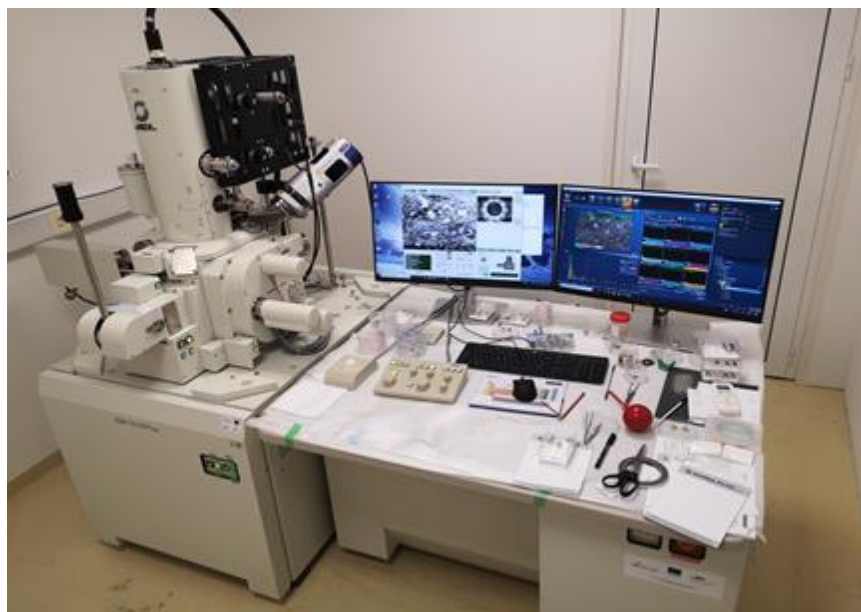
Slika 13. JEOL- JSM-7610FPlus, naziv i model uređaja pomoću kojeg je izvršen SEM.
