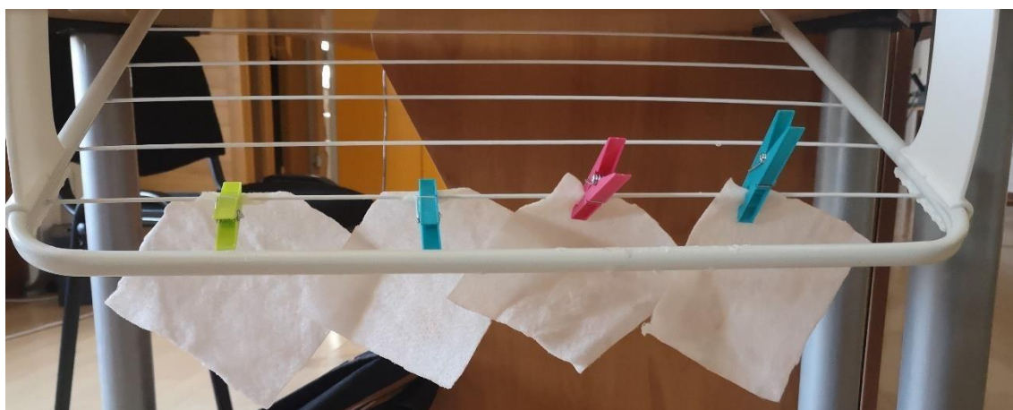
Slika 12. Vertikalno sušenje bijelog ne-tkanog materijala natopljenog u sol.
