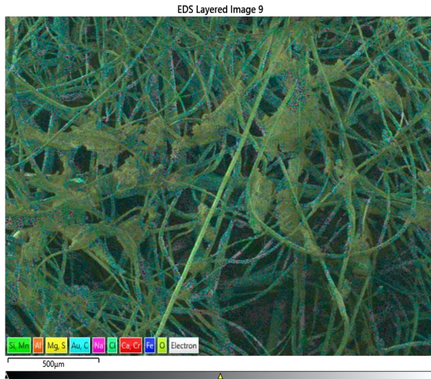
Slika 43. Prikaz rezultata mapiranja kemijskih elemenata za himalajsku sol ( 30g soli u 100ml vode).
