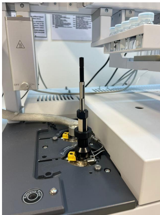
Slika 9. SPME držač s iglom umetnutom u GC-MS injektor
