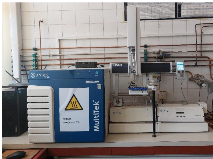
Slika 21. Aparatura za određivanje dušika metodom oksidativnog spaljivanja i kemiluminescencije
