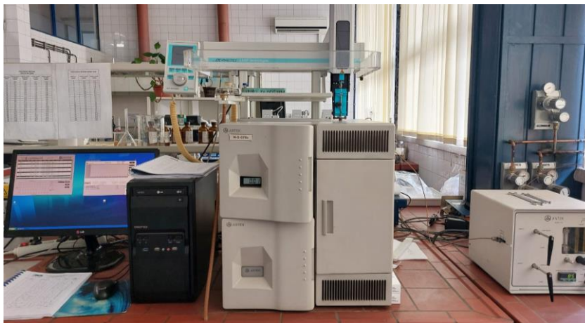
Slika 20. Laboratorijski prikaz instrumenta za UV fluorescencijsku detekciju sumpora
