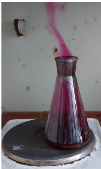
Slika 24. Dokaz postojanja olova u reformat benzinu
