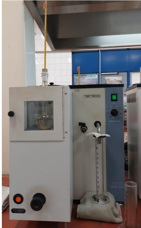
Slika 18. Aparatura za ručnu destilaciju
