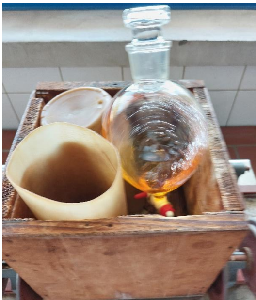
Slika 23. Mućkanje reformat benzina i jod-monoklorida
