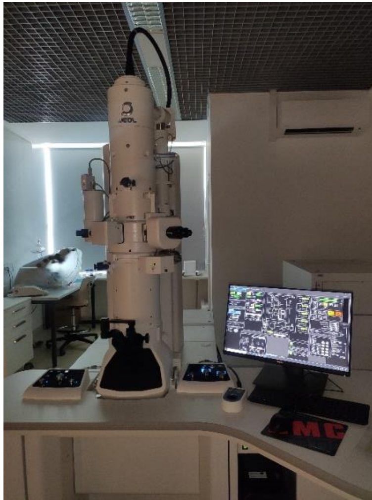
Slika 15. Jeol JEM 1400Flash elektronski mikroskop
