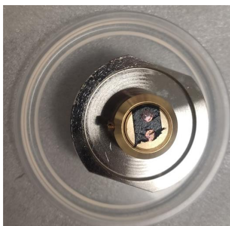
Slika 19. Nosač uzorka za snimanje na SEM-u
