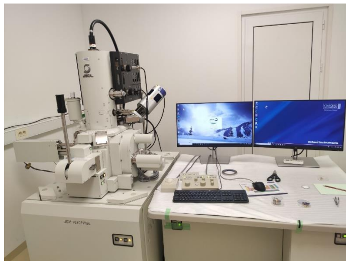
Slika 18. Jeol JEM -7610F Plus pretražni elektronski mikroskop
