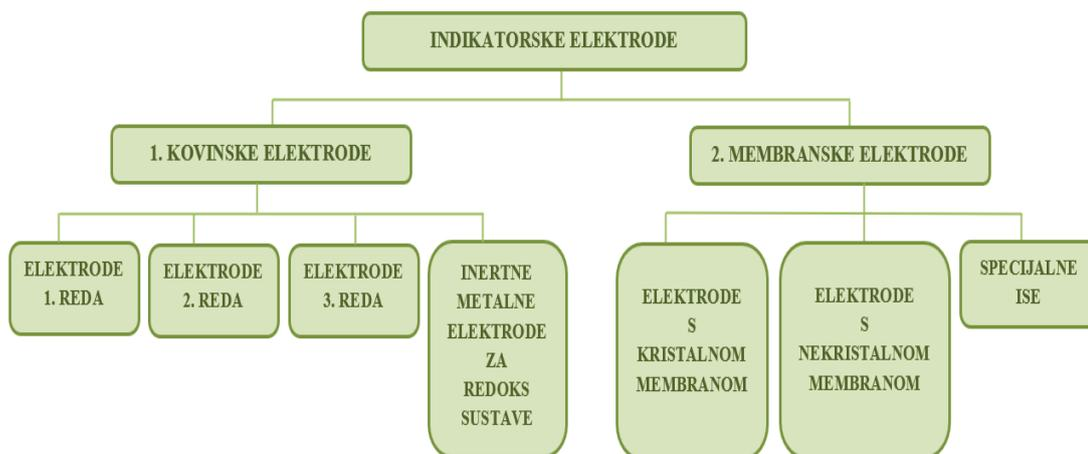
Slika 5. Shema podjele indikatorskih elektroda<sup>5</sup>
