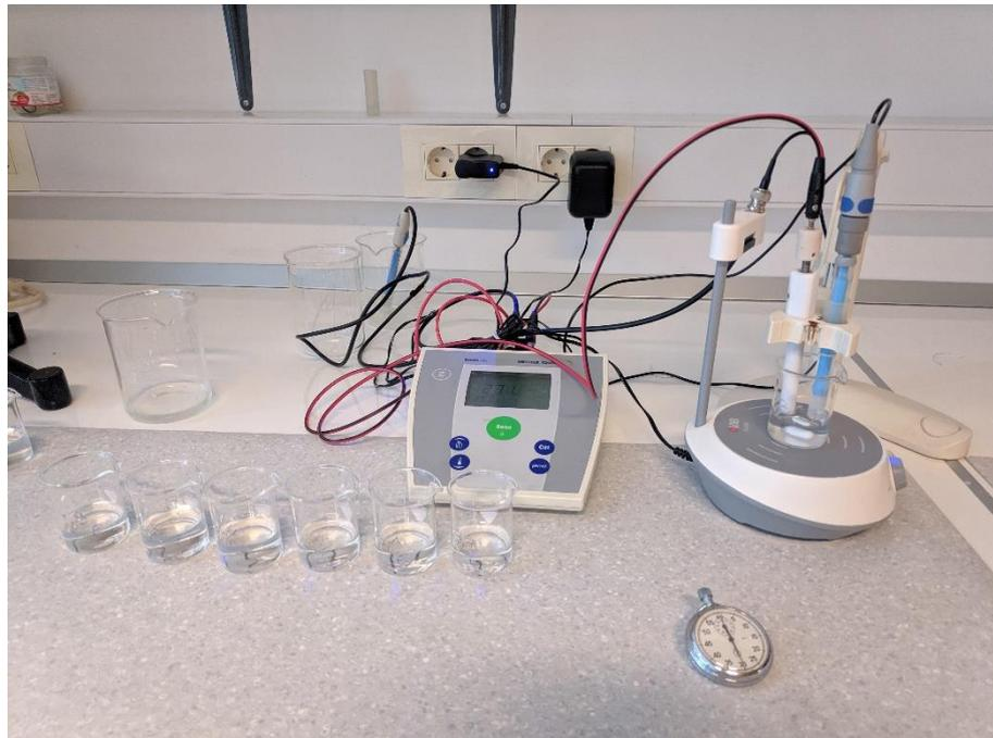
Slika 24 . *Potenciometrijsko mjerenje*
