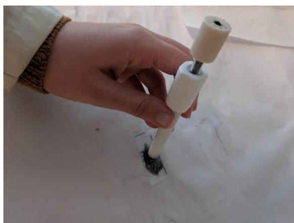
Slika 23. Poliranje membrane
