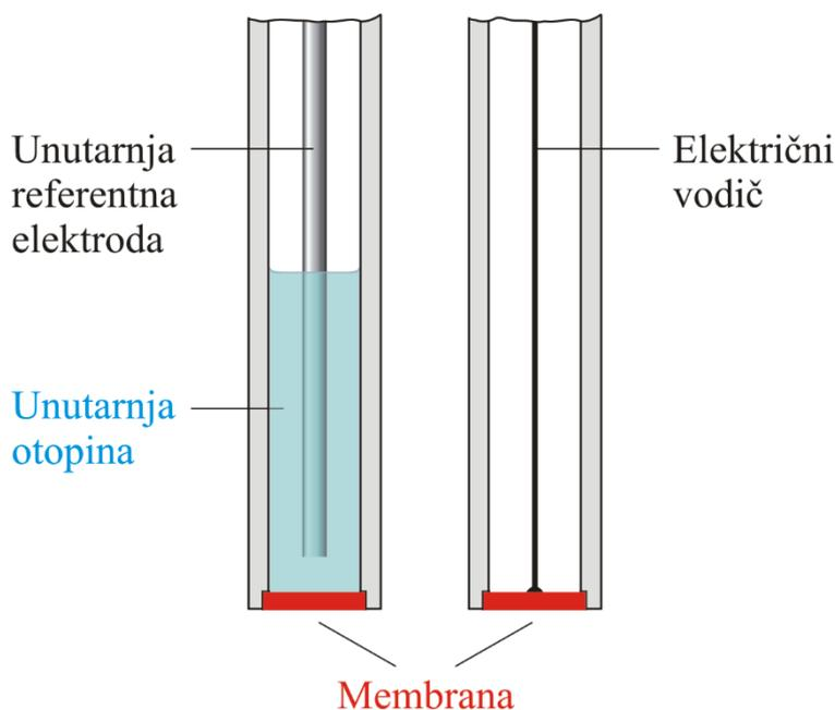
Slika 8. Elektrode s kristalnom membranom<sup>5</sup>
