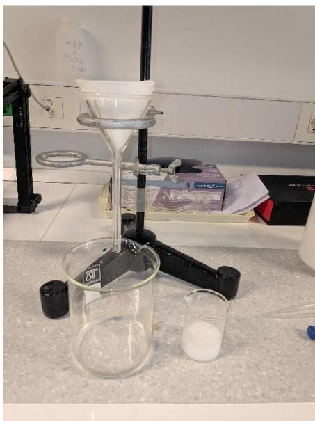
Slika 19. Filtracija nastalog taloga
