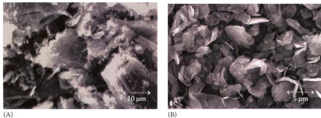
Slika 12. Mikrostruktura dva tipična spektroskopska grafitna praha snimljena elektronskim mikroskopom<sup>12</sup>
