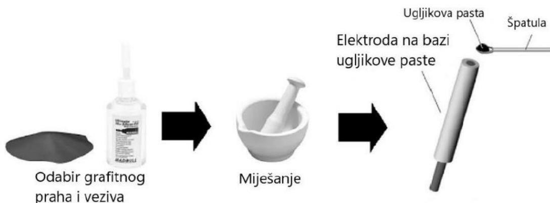
Slika 10. Proces pripreme elektrode na bazi ugljika<sup>14</sup>
