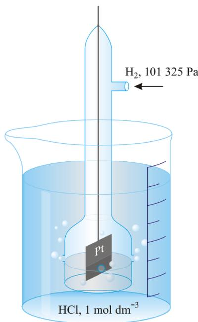
Slika 2. Standardna vodikova elektroda<sup>5</sup>
