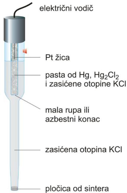
Slika 3. Kalomel elektroda<sup>5</sup>
