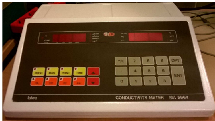
Slika 4. Aparatura za određivanje specifične provodnosti: a) osobno računalo, b) ćelija za termostatiranje i elektroda od nehrđajućeg čelika, c) konduktometar MA 5964
