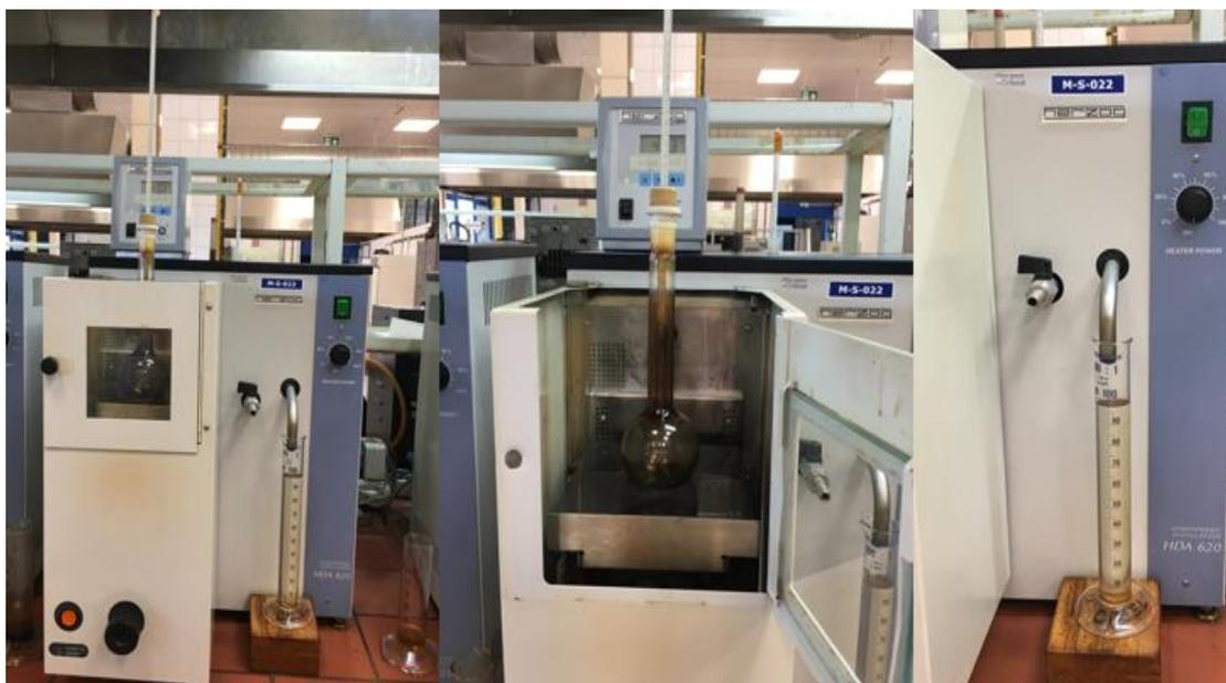
Slika 28. Prikaz aparature za ručnu destilaciju
