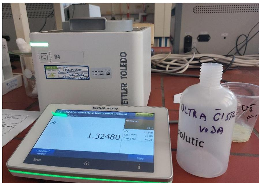
*Slika 26. Automatski digitalni refraktometar za mjerenje indeksa refrakcije*
