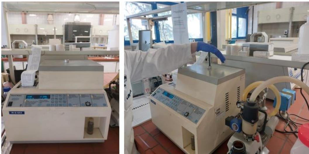
*Slika 38. Termostatirana komora za određivanje tlaka pare uzorka*
