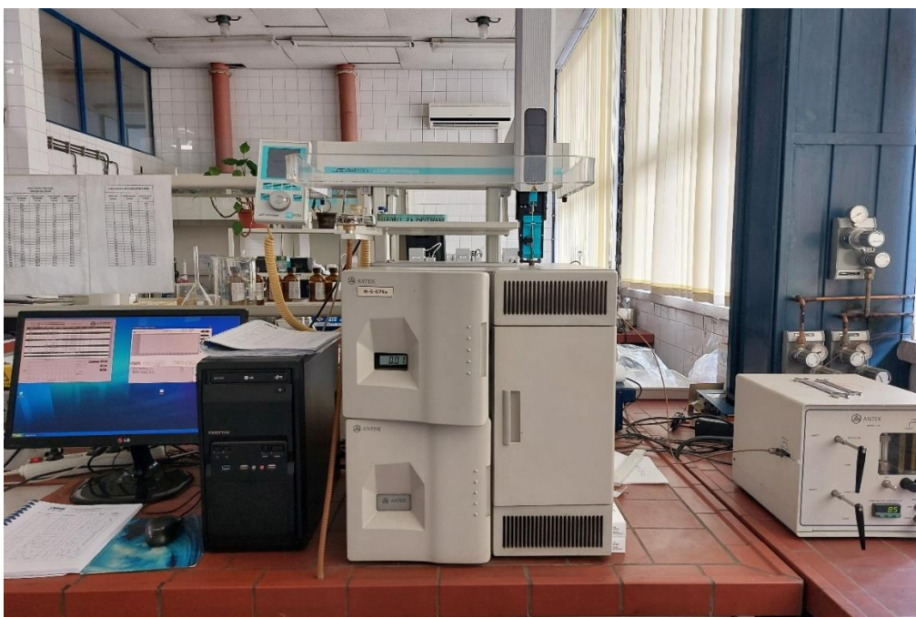
Slika 33. UV-F spektrometar za određivanje količine ukupnog sumpora na uzorku FCC benzina
