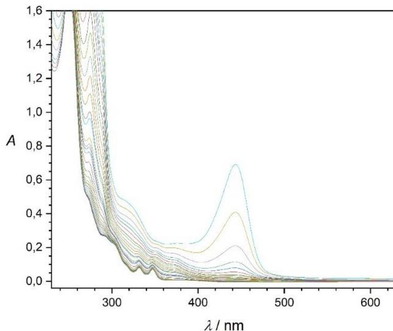
**Slika 13.** Spektrofotometrijska titracija spoja **D** ( $c_0 = 1,96 \times 10^{-5} \text{ mol dm}^{-3}$ ) s fluoresceinom ( $c_0 = 1,88 \times 10^{-3} \text{ mol dm}^{-3}$ ) u sustavu otapala acetonitril/diklormetan pri sobnoj temperaturi. Spektri su korigirani za razrjeđenje.
