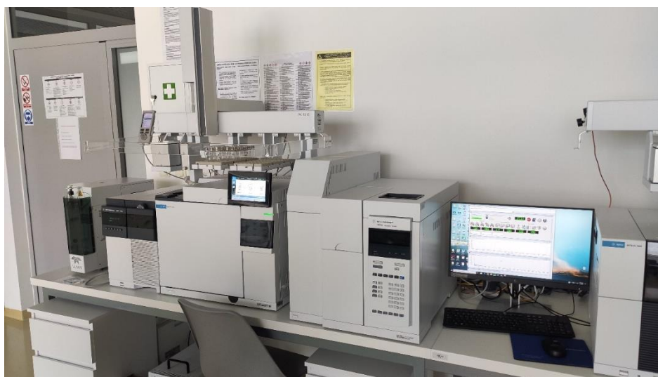
Slika 13. Vezani sustav plinska kromatografija-spektrometrija masa (GC-MS)
