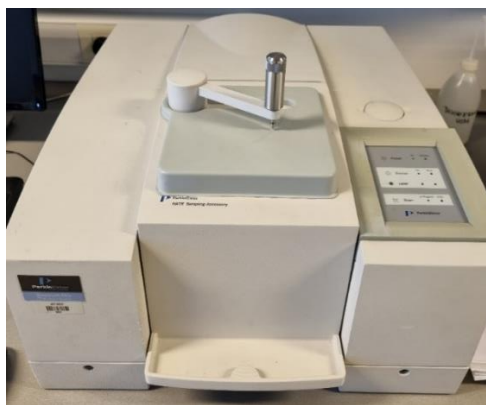
Slika 18. FT-IR uređaj s dodatkom za snimanje HATR tehnikom
