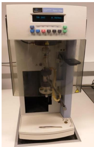
Slika 22. Aparatura za termogravimetrijsku analizu Perkin-Elmer Pyris 1 TGA
