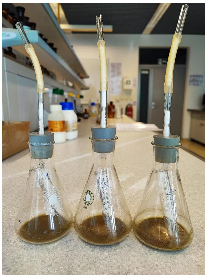
**Slika 12.** Određivanje karbonata u tlu gravimetrijskom metodom
