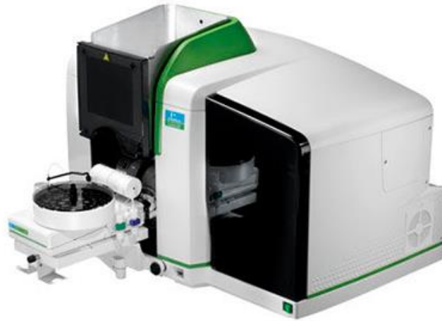
Slika 2.5. Uređaj za atomsku apsorpcijsku spektrometriju Perkin Elmer PinAAcle 900F AAS 28 .
