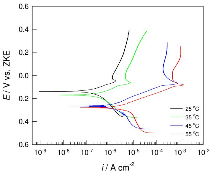
**Slika 16.** Potenciodinamičke polarizacijske krivulje za Cu s prevlakom propolisa u  $0,5 \text{ mol dm}^{-3}$  NaCl otopini pri različitim temperaturama elektrolita
