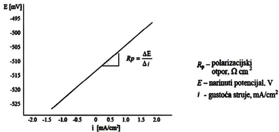
Slika 5. Određivanje polarizacijskog otpora<sup>(33)</sup>
