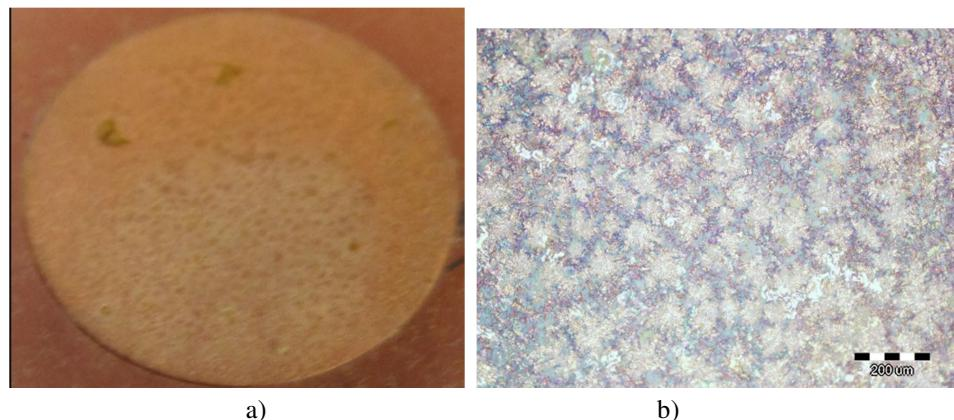
**Slika 21.** Površina Cu elektrode nakon potenciodinamičkog polarizacijskog ispitivanja u mirujućoj NaCl otopini uz dodatak propolisa pri  $T = 25 \text{ }^{\circ}\text{C}$ : a) makro snimka površine, b) snimka optičkim mikroskopom uz uvećanje 100 puta
