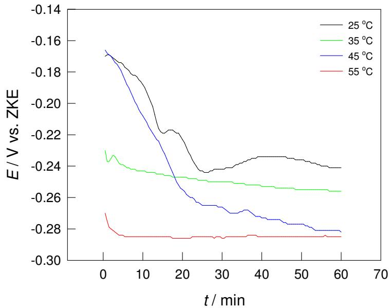
Slika 9. Potencijal otvorenog strujnog kruga za Cu u  $0,5 \text{ mol dm}^{-3}$   $\text{NaCl}$  otopini uz dodatak 4 ml propolisa pri različitim temperaturama elektrolita
