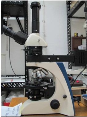
Slika 7. Uređaji korišteni za ispitivanja površine elektroda: a) Optički mikroskop Bk-Polr, b) Optički mikroskop Olympus GX51, c) Pretražni elektronski mikroskop Tescan Vega TS5136LS
