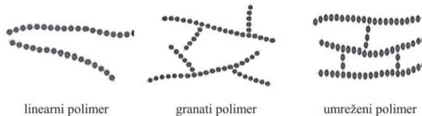
Slika 2. Podjela polimera prema obliku makromolekula 4
