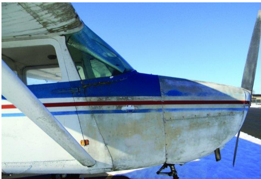
Slika 1.6. Korozija u zrakoplovnoj industriji.
