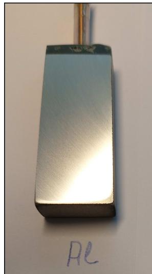
*Slika 2.1 Izgled pripremljene elektrode od Al-legure*
