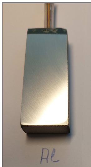
Slika 2.1 Izgled pripremljene elektrode od Al-legure
