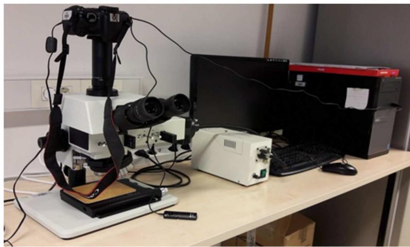
Slika 2.4 Svjetlosni mikroskop MXFMS-BD, Ningbo Sunny Instruments co.
